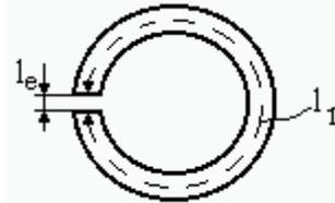
El núcleo está compuesto por un material ferromagnético y otro no ferromagnético (aire en este caso), dispuestos uno a continuación del otro, por lo que la reluctancia total del circuito será:
