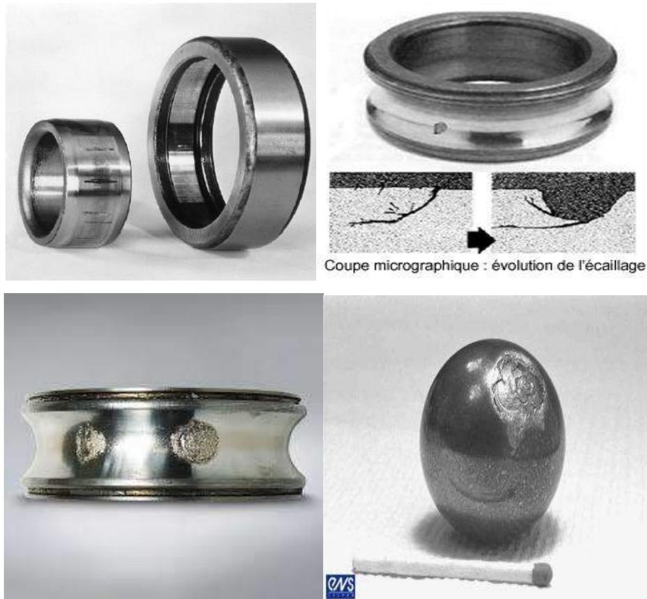
Figure 6. Défauts de roulements
