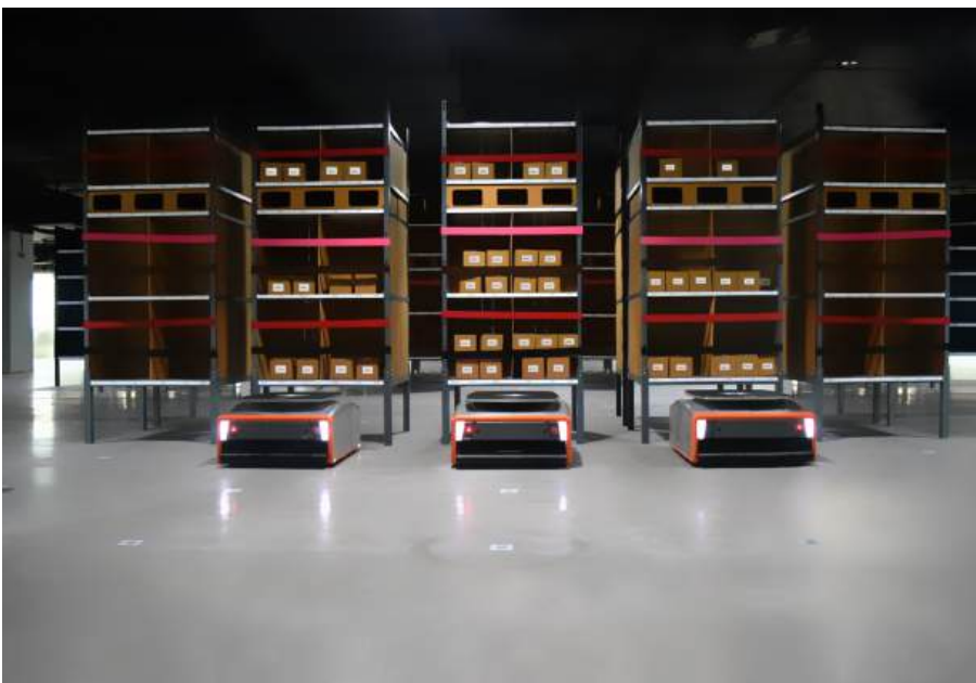
Figura 24. Plataformas móviles que desplazan estanterías hasta la ubicación donde deben realizar el picking
