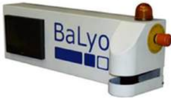
Figura 4. Dispositivo que transforma un vehículo logístico en un AIV
