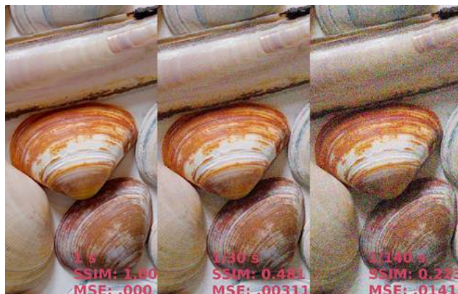
Figura 1 - Ruído de imagem / Fonte: https://commons.wikimedia.org/wiki/File:Noise_comparison_NIND_shells_200-5000-H2.jpg . Acesso em: 21 set. 2023.
