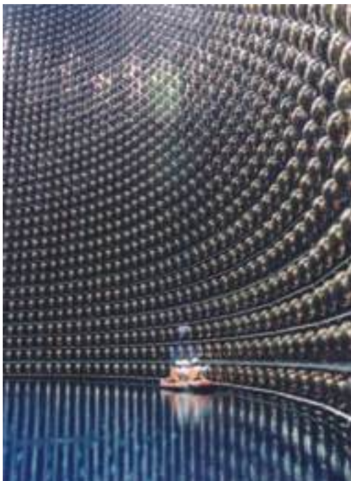
38- Técnicos num bote de borracha dentro do detector de neutrinos Super Kamiokande, no Japão. O tanque está localizado a um quilômetro abaixo da superfície, contém 50.000 metros cúbicos de água pura e é internamente rodeado por 11.200 fotodetectores (crédito: Kamioka Observatory).
