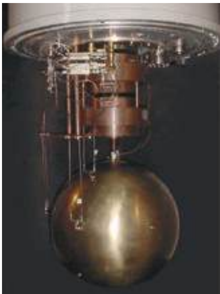
40- Detector Mário Schenberg de ondas gravitacionais, instalado no Instituto de Física da USP, em São Paulo, visto aqui sem a cápsula de isolamento térmico que o envolve. A antena é uma esfera maciça de uma liga de cobre (94%) e alumínio (6%) com 65 cm de diâmetro e massa de cerca de uma tonelada (crédito: INPE).
