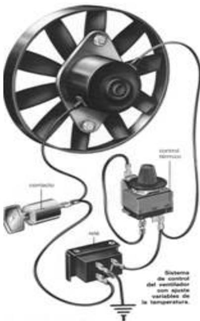
Todos los vehículos con motor transversal y con tracción delantera llevan ventilador eléctrico.
