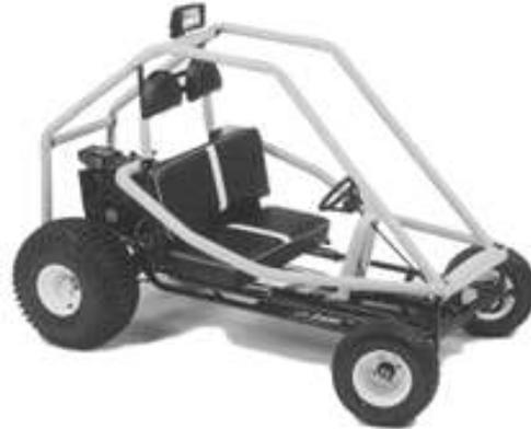
Esta técnica utiliza como estructura del vehículo una red de finos tubos metálicos soldados, recubierta después con láminas metálicas, frecuentemente de metales ligeros como Aluminio o Magnesio.
