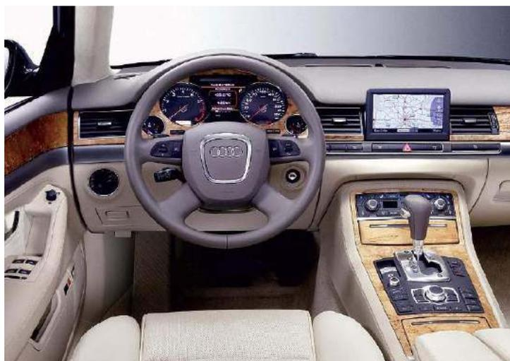
En el tablero de la cabina, los mandos de audio y video se encuentran en el timón, además cuentan con pantallas de navegación, y sistema de información digital sobre parámetros del motor
