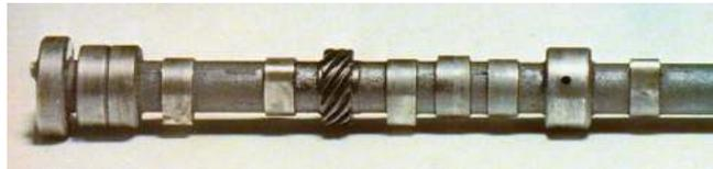
Según el diseño del motor, puede ejecutar cierto número de funciones adicionales. El engranaje hiperbólico puede actuar sobre el distribuidor y sobre la bomba de aceite, mientras que un resalte extra puede accionar una bomba mecánica de carburante. Unida al extremo anterior del árbol se encuentra una polea que recibe movimiento giratorio desde el cigüeñal mediante una o más cadenas, correas o fajas de transmisión.
