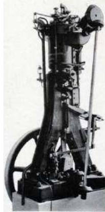
Prototipo del motor diesel.
