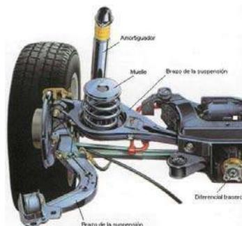
El esquema de suspensión lo conforman dos grandes brazos: uno longitudinal al eje y otro transversal. En este caso el muelle y el amortiguador no están dispuestos en el mismo eje uno dentro del otro, posiblemente para ganar espacio en el maletero.
