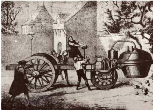
El vehículo de *Cugnot* denominado “*El Fardier*” era un triciclo de unas 4,5 toneladas, motor bicilíndrico de 50,000 cc (304 mm de diámetro x 356 mm de carrera), con ruedas de madera y llantas de hierro, cuyo motor estaba montado sobre el eje de las ruedas de un carro para transportar cañones.
