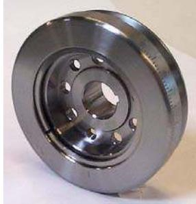
El damper tiene como función principal equilibrar estática y dinámicamente al cigüeñal y eliminar las vibraciones.
