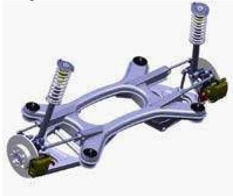
Tipo de suspensión que recurre a múltiples brazos que unen el chasis a las ruedas. Con ello se consigue una menor inclinación de la carrocería a la hora de afrontar las curvas y una mayor adherencia, puesto que permite rectificar constantemente la caída de los neumáticos, de modo que hay un mayor contacto con el asfalto.
