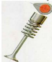
Válvula en cabeza con el árbol de levas directamente encima de la cámara de combustión. Este es el método más eficaz y es muy usado en motores modernos
