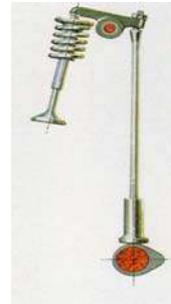
Válvula en cabeza operada por el procedimiento más habitual de los balancines colocados en un eje.
