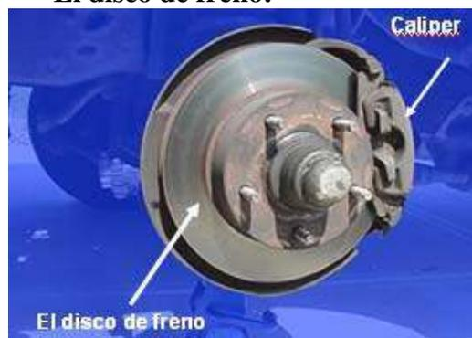
Está formado por un disco metálico de acero, que forma la parte móvil a detener durante el frenado por contacto con el elemento de fricción, en este caso las pastillas de freno.
