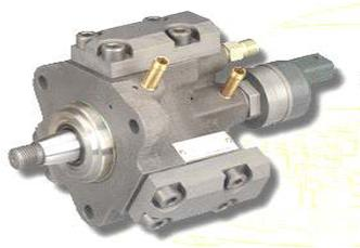
La bomba de alta presión, es accionada por el cigüeñal del motor a través de una cadena, faja o rueda dentada. Gira a la mitad de las revoluciones del motor. La bomba se lubrica y refrigera por el combustible.
