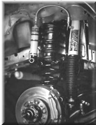
Añaden un gas (que puede ser nitrógeno) que además de amortiguar también hace en cierto modo de resorte elástico, es por ello que este tipo de amortiguadores vuelven a su posición cuando se deja de actuar sobre ellos.
