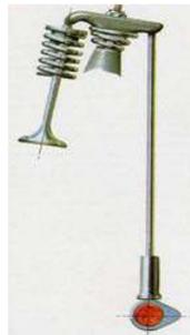
Válvula en cabeza operada por un empujador y un balancín individual, movidos por árbol de levas inferior. No hay eje de balancines en este modelo.
