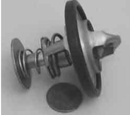
La misión del termostato es impedir, cuando el motor está frío, la circulación del líquido por el radiador, desviándolo directamente a la bomba, para que lo devuelva al circuito de enfriamiento, logrando así un calentamiento rápido.
