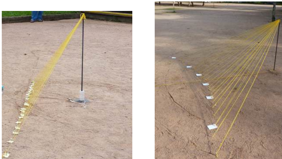
Figura 7.1: Observações com um gnômon em Porto Alegre no equinócio de outono (esquerda) e no solstício do inverno (direita). As linhas amarelas ligam a ponta do gnômon à ponta da sombra nas várias medidas. A sombra mínima dá a direção norte-sul.
