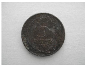
Fig.44. Productos de corrosión de la moneda Nº11
