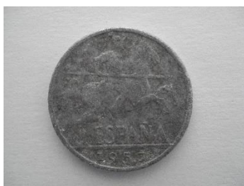
Fig.46. Pátina estable de óxido de aluminio.
