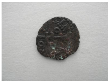
Fig.36. Cloruro de cobre activo en la moneda N°3.
