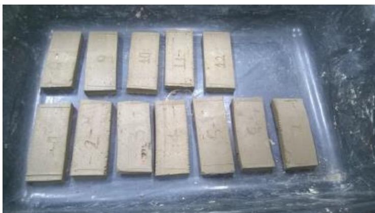
Figura 2. Corpos de prova após secagem a 110°C.
