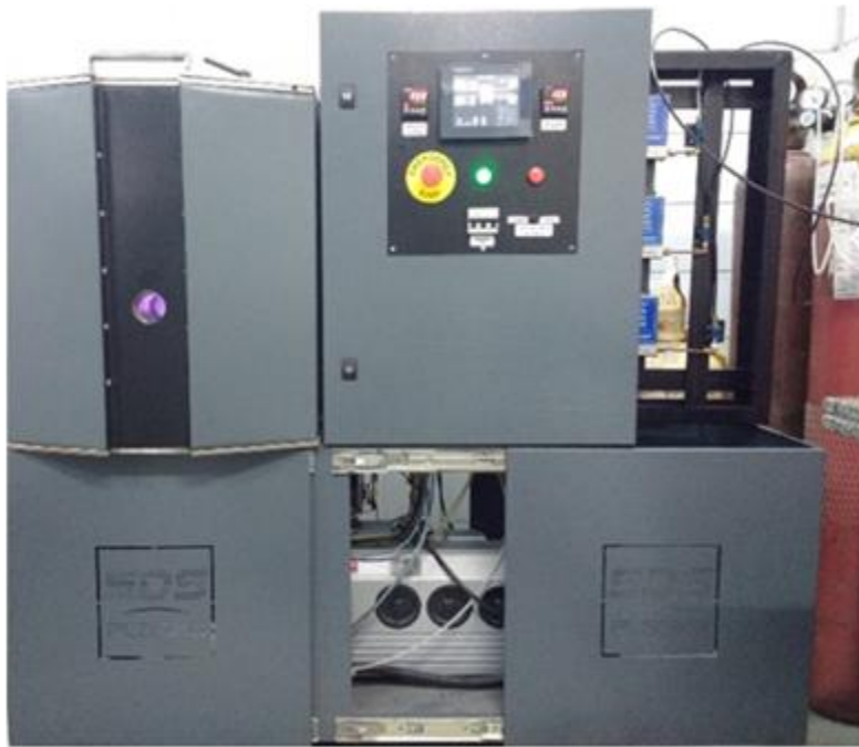
Figura 3 – Aspecto visual do reator utilizado para a deposição dos filmes finos.
