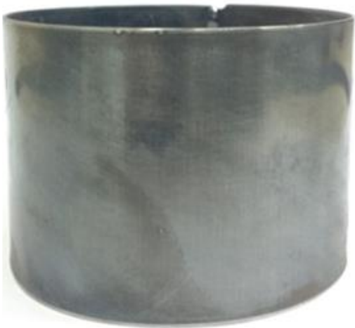
Figura 2 – Imagem do cátodo oco de aço inox.
