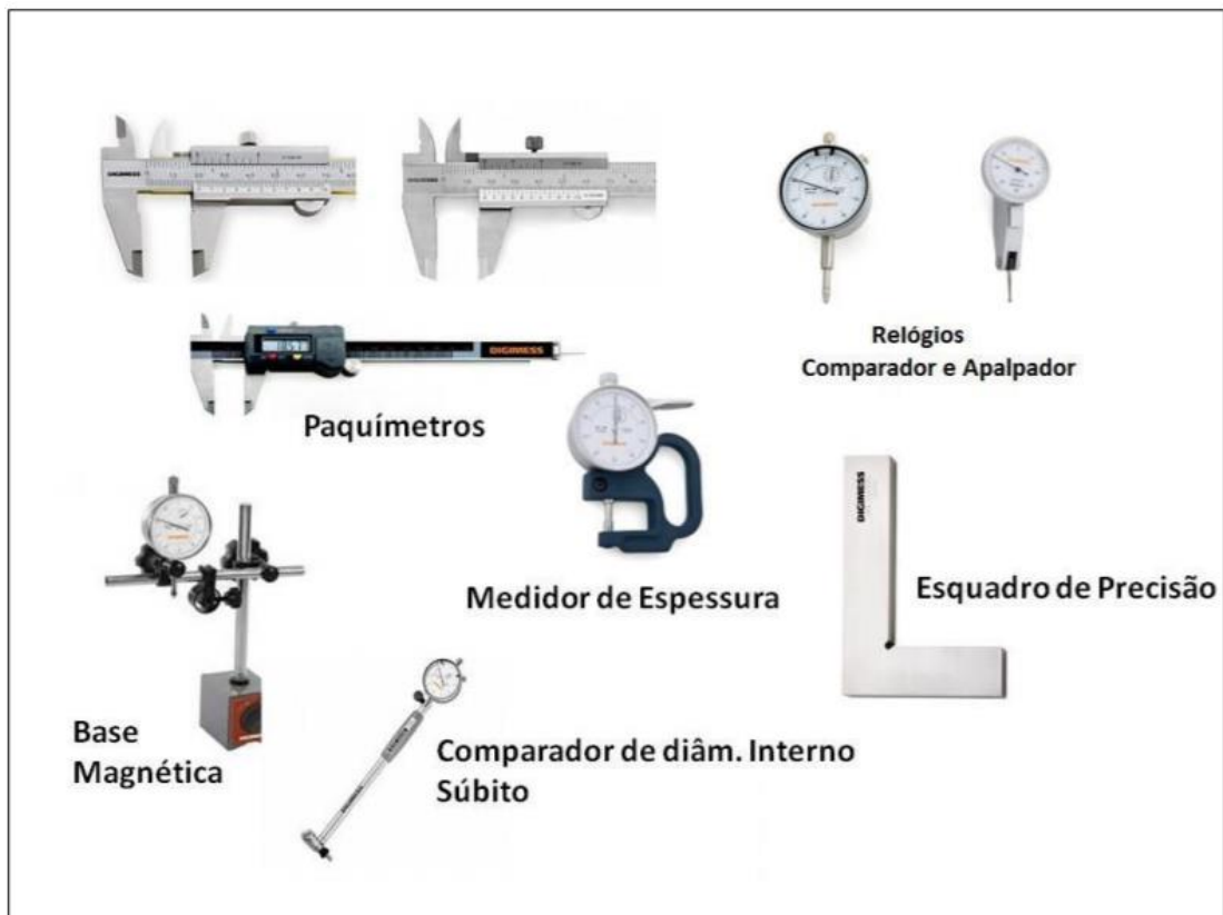
Figura 1. Equipamentos de Medição.
