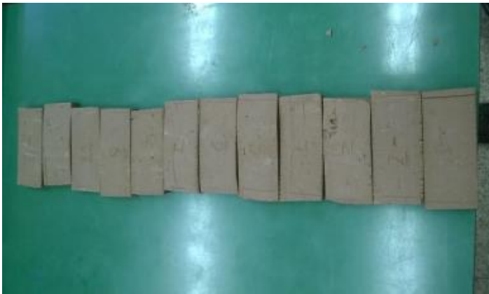
Figura 3. Corpos de prova após queima a 950°C.
