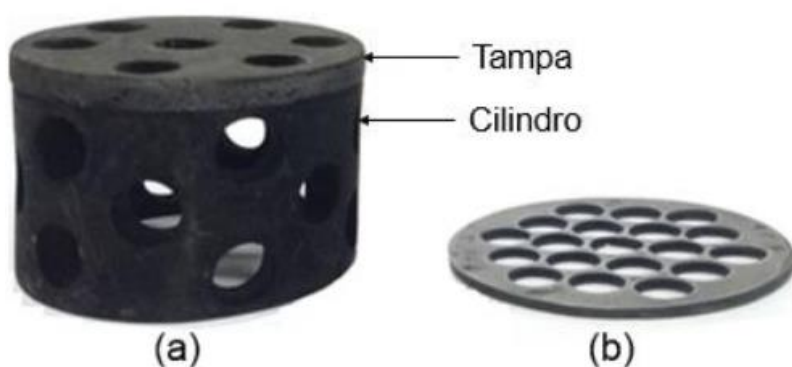
Figura 1 – Imagens da (a) Gaiola de grafita e (b) tampa de titânio.
