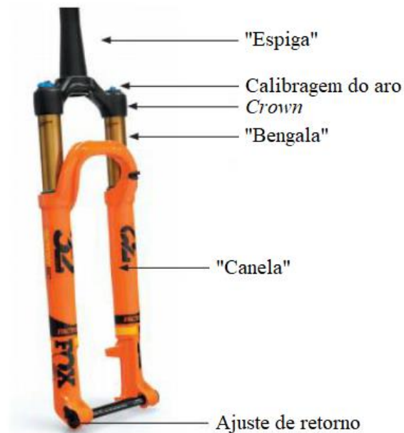
Figura 3 – Partes componentes de suspensão dianteira analisada.
