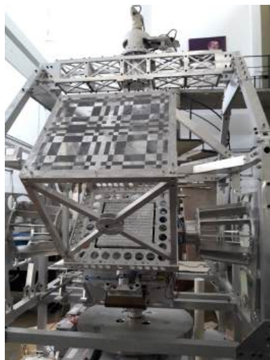
Figura 2.19: O telescópio ProtoMirax para raios X, com o padrão de aberturas na parte superior. Fonte: autor.
