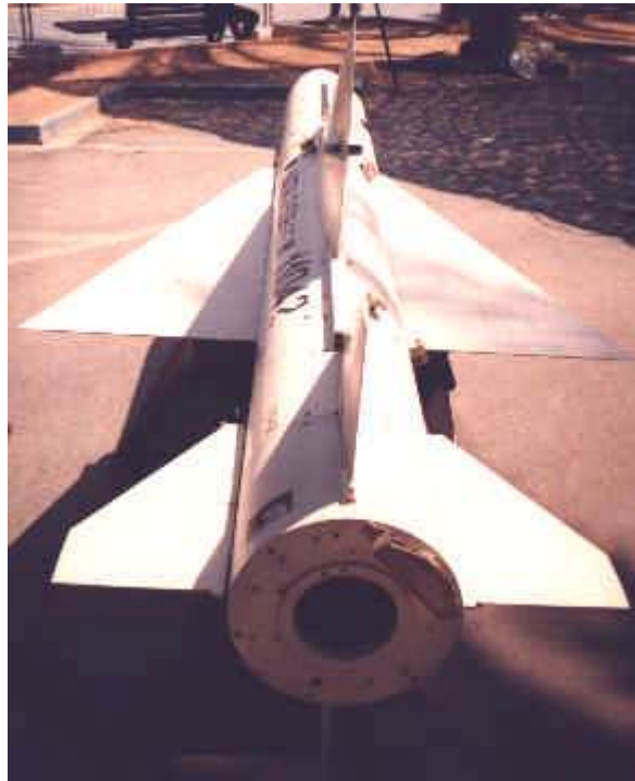
Misil R-530 equipado con motor cohete. Utiliza carburante sólido.
