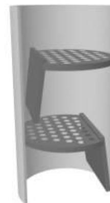
Figura 6.3. Parte de uma Coluna de Destilação
