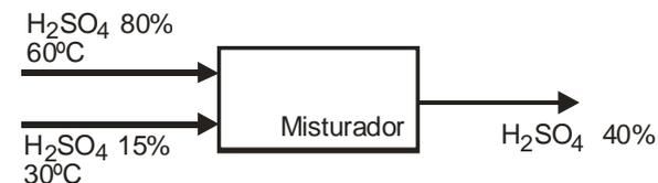
Figura 3.16. Sistema de mistura de ácido sulfúrico.
