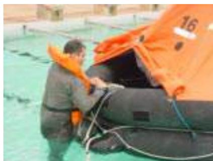
Se durante o lançamento da balsa salva-vidas, ela inflar de cabeça para baixo, você poderá facilmente desvirá-la. Para isso, suba na balsa e fique sobre o cilindro de CO<sub>2</sub>, em seguida, puxe o cabo de endireitamento localizado na parte inferior da balsa.
