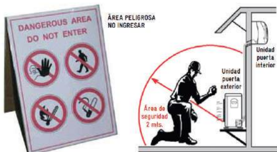
ILUSTRACIÓN 50. SEÑALIZACIÓN DE ÁREA DE TRABAJO.
