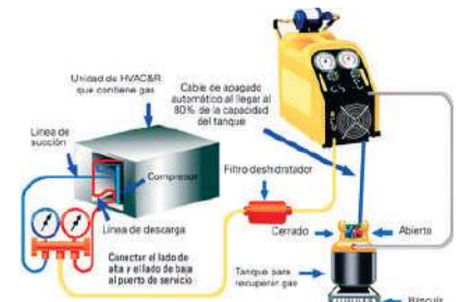
ILUSTRACIÓN 32. MÉTODO DE RECUPERACIÓN EN FASE LÍQUIDA.
