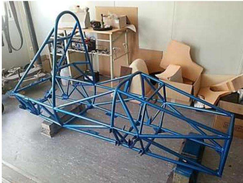
Figura 3: Primer chasis tubular del equipo ARUS (ART-14)
