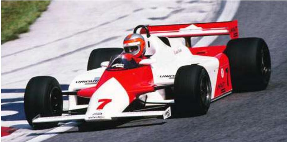
Figura 2: MP4/1, primer monocasco fabricado en composites.
