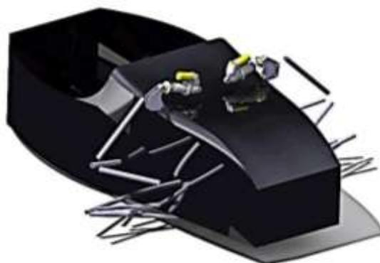
Figura 19: Modelo final del cockpit con suspensión y amortiguación delantera
