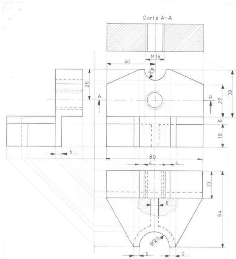
3.1.3. Dadas las vistas frontal y superior, realizar la proyección isométrica, los cortes indicados y el respectivo acotado.
