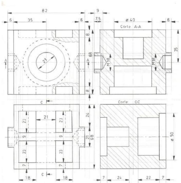
3.1.8. Dadas las vistas frontal y lateral izquierda, realizar la proyección isométrica, la vista superior, el corte indicado y el respectivo acotado.
