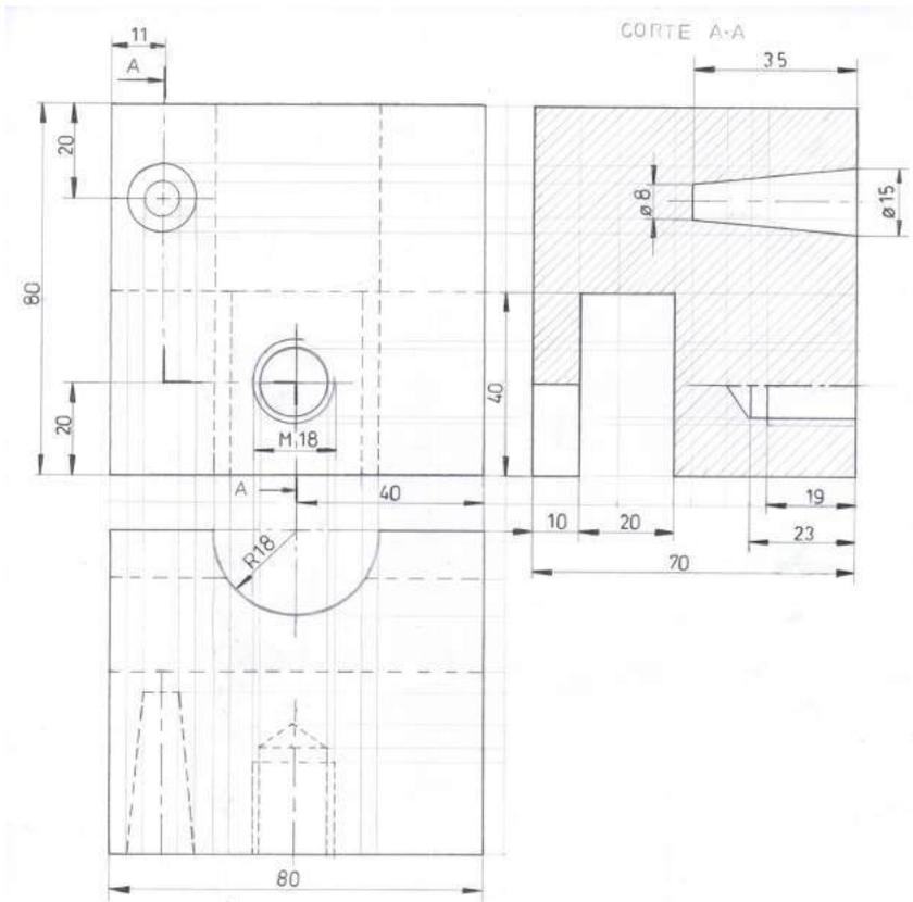
3.1.7. Dadas las vistas frontal y superior, realizar la proyección isométrica, los cortes indicados y el respectivo acotado.
