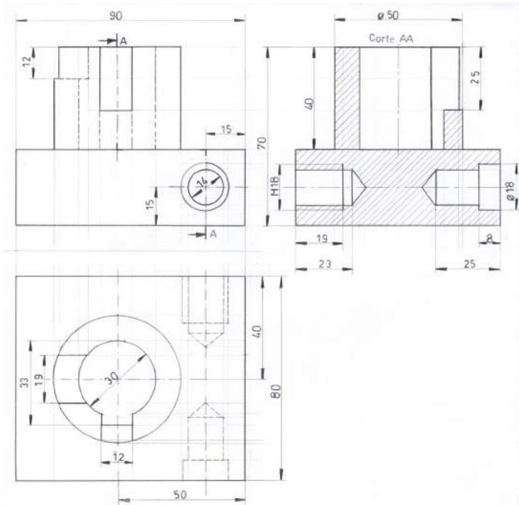
3.1.6. Dadas las vistas frontal y superior, realizar la proyección isométrica, el corte indicado y el respectivo acotado.
