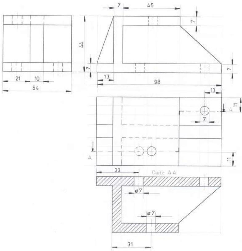
3.1.5. Dadas las vistas frontal y superior, realizar la proyección isométrica, el corte indicado y el respectivo acotado.
