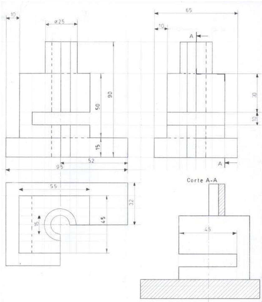
3.1.2. Dadas las vistas frontal y superior, realizar la proyección isométrica, la vista lateral derecha, el corte indicado y el respectivo acotado.
