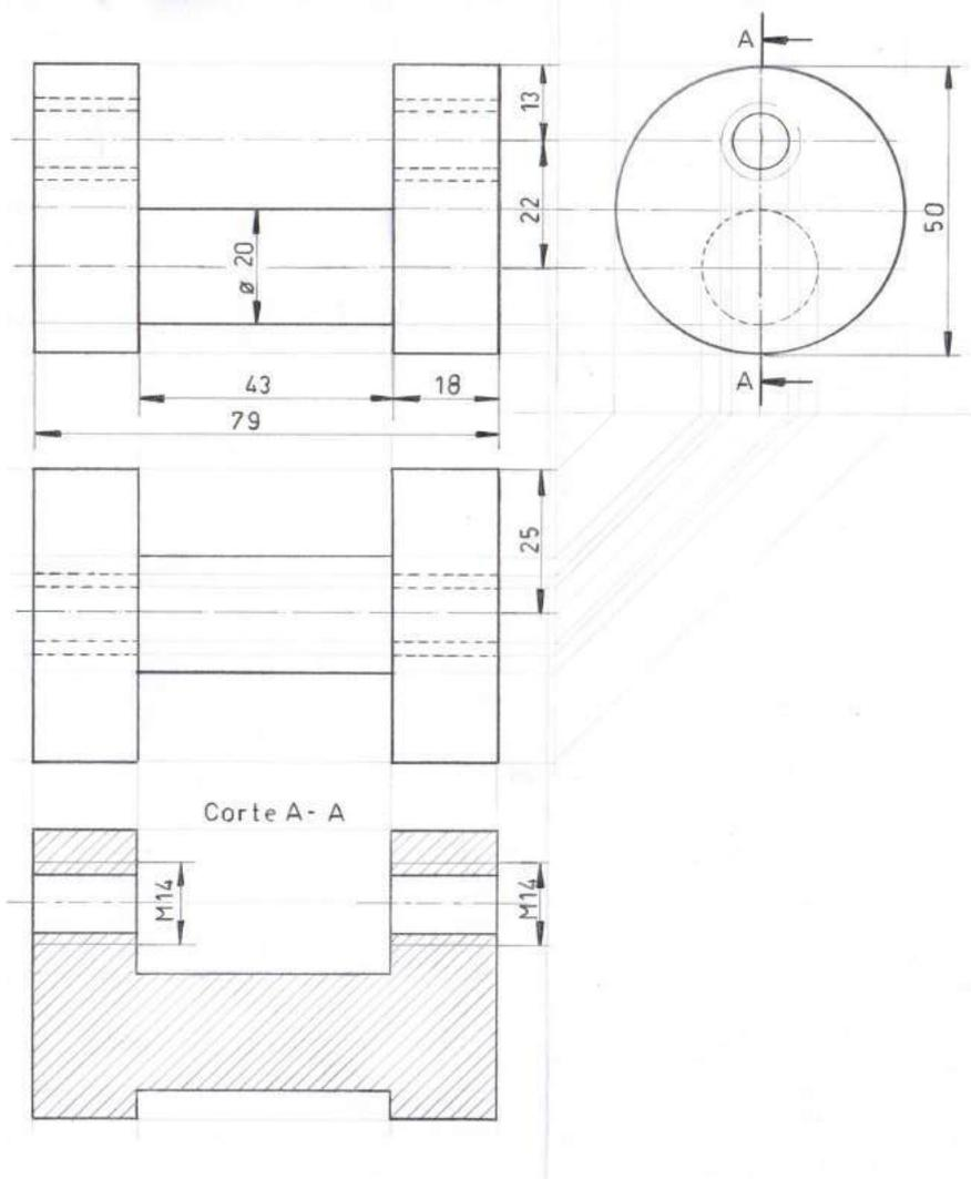
3.1.10. Dadas las vistas frontal y lateral derecha, realizar la proyección isométrica, la vista superior, el corte indicado y el respectivo acotado.
