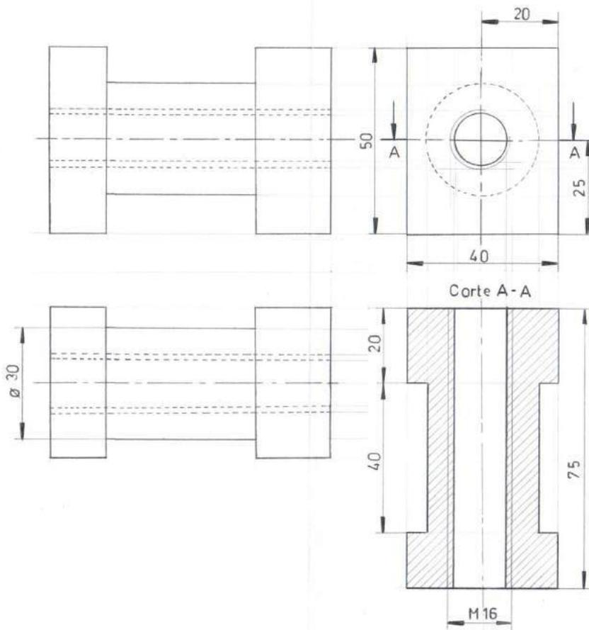
3.1.9. Dadas las vistas frontal y lateral izquierda, realizar la proyección isométrica, la vista superior, el corte indicado y el respectivo acotado.
