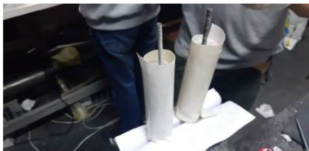
Figura 18 – Grãos nas barras roscadas para que a resina cure
