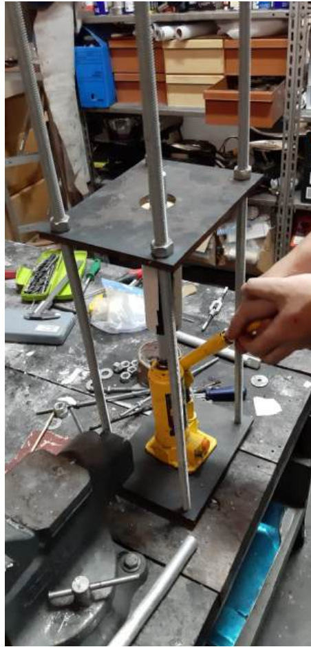
Figura 16 – Utilização do macaco hidráulico para desmolde do grão
