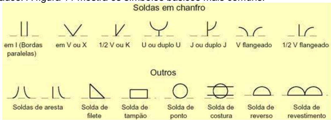
Figura :Símbolos básicos de soldagem
