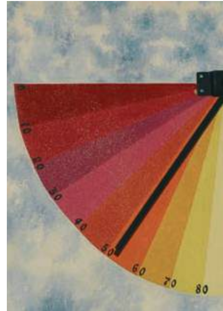
Detalle del cuadrante del Instrumento de Pasos, el que tiene diferentes tonalidades en intervalos de 10°.
