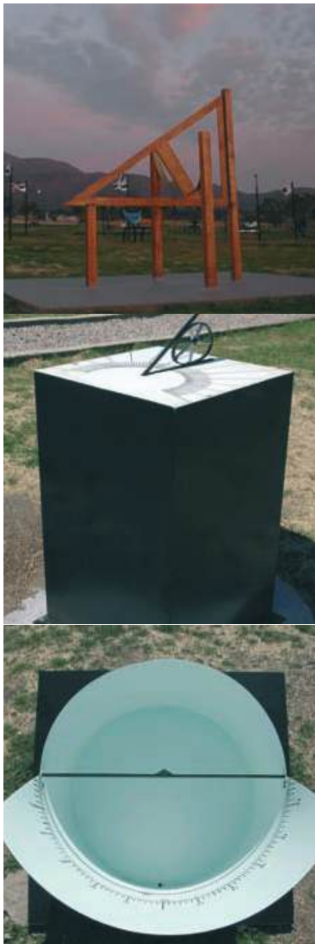
SUPERIOR. Reloj Solar Ecuatorial. MEDIO. Reloj Solar Horizontal. INFERIOR. Reloj Solar Cilíndrico.
