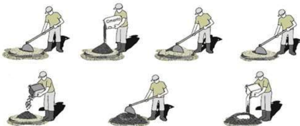
Figura 31 – Mistura manual de concreto.
