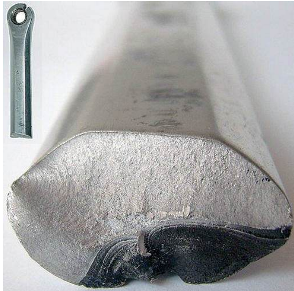
Figura 33: Exemplo de fratura por fadiga.
