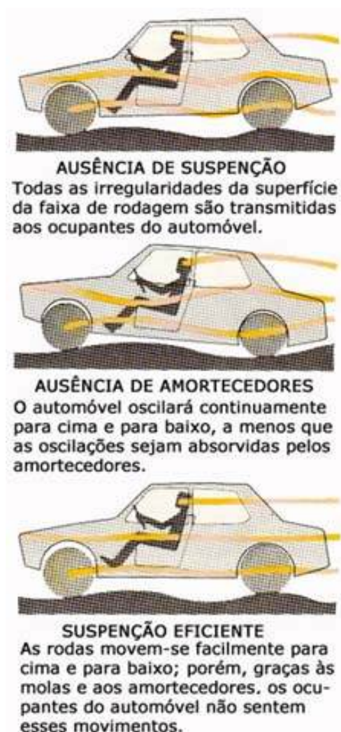
Figura 16: Princípio de funcionamento da suspensão.
