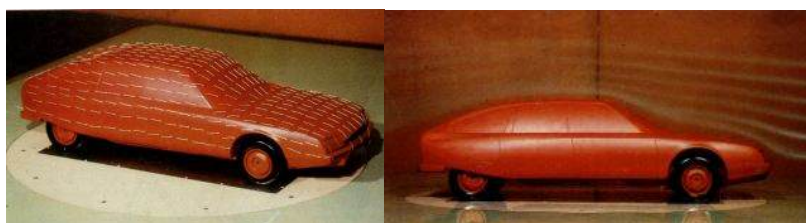
Figura 29: Mecanismos para visualização do escoamento.
