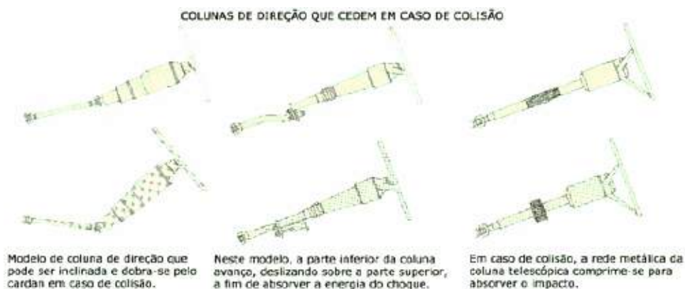
Figura 23: Esquemas de direções seguras em casos de colisão frontal.
