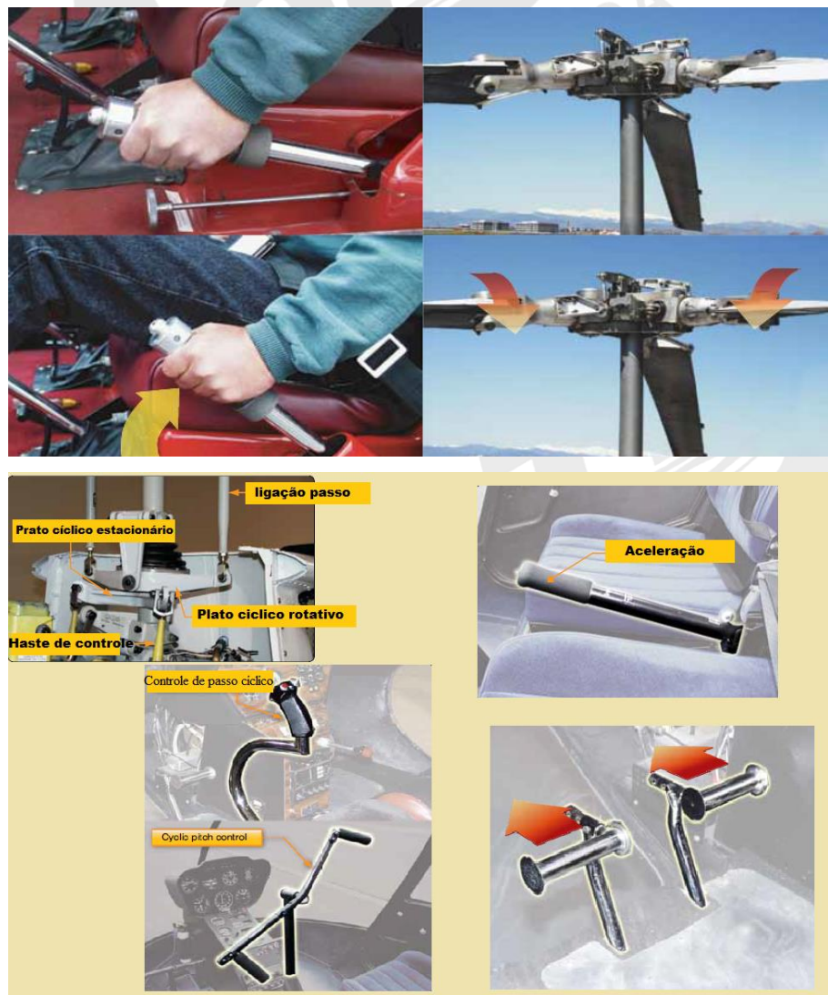
Figura 13-46 Sistema de controle de helicóptero convencional.
