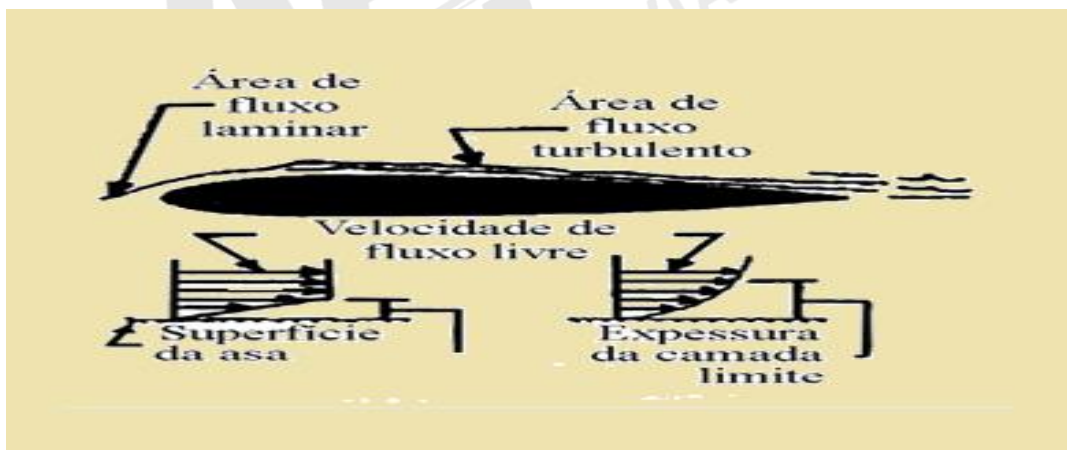
Figura 13-31 Características da camada limite.
