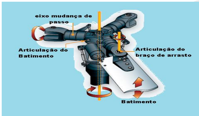
Fonte: FAA - Mechanic Training Handbook-Airframe Figura 13-40 Cabeça de rotor articulado.
