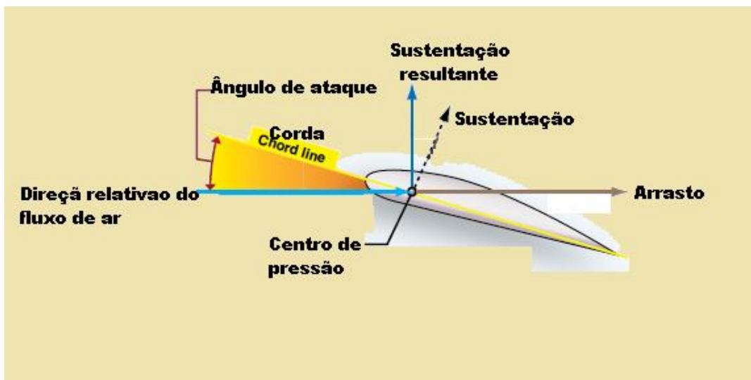
Figura 13-4 Ângulo de ataque positivo.
