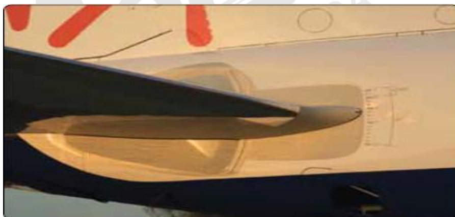
Figura 13-24 Estabilizador horizontal móvel.
