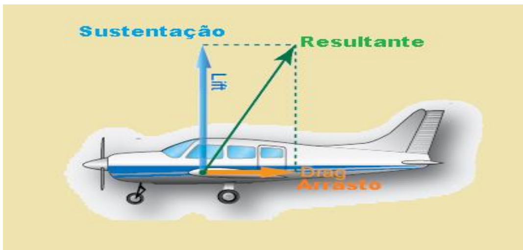
Figura 13-8 Resultante da sustentação e do arrasto.
