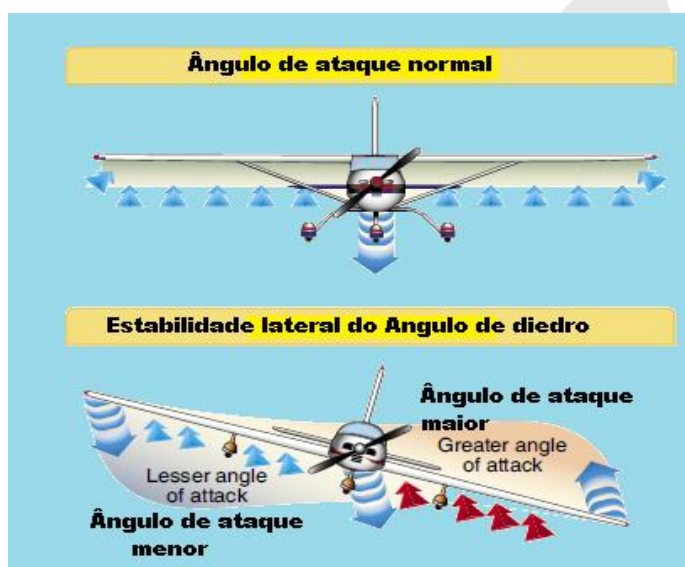
Figura 13-14 Contribuição do diedro para a estabilidade lateral.
