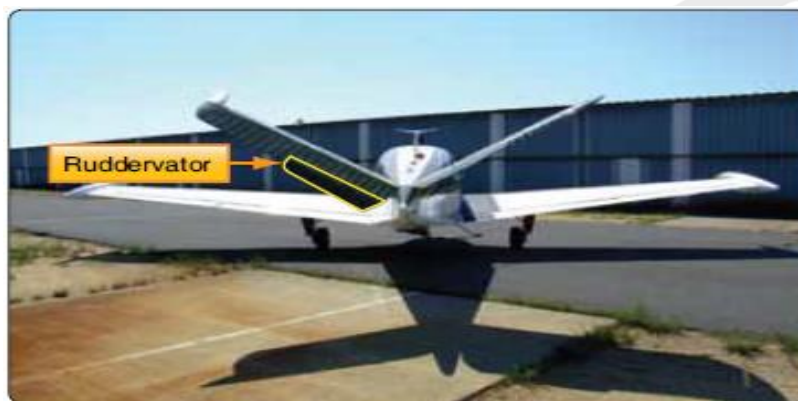
Figura 13-26 Ação dos Ruddervators
