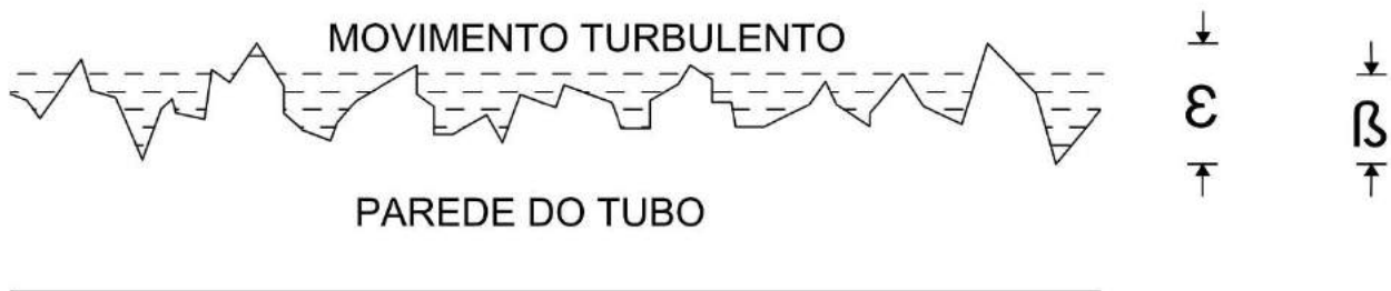
Figura 7. Detalhe da parede rugosa ( \beta \leq 4\varepsilon ) de uma tubulação. Sendo f = f_3(\varepsilon/D) .
