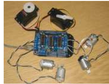
Fig. 7. Shield para control de motores DC y servos acoplado a una tarjeta Arduino
