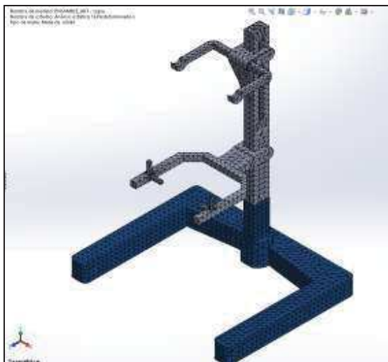
Figura 6: Mallado aplicado al soporte parcial de peso.
