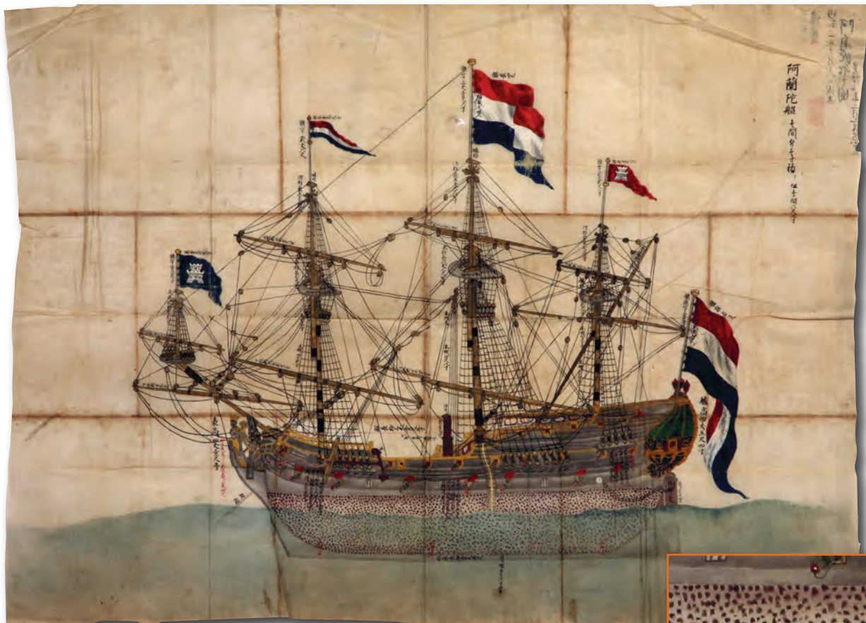
7.40 Een VOC-retourschip van de Kamer van Zeeland met de vlag van Middelburg uit de periode 1750-1780 op een Chinese prent. Tot boven de waterlijn zijn de wormspijkers als rode puntjes getekend.
