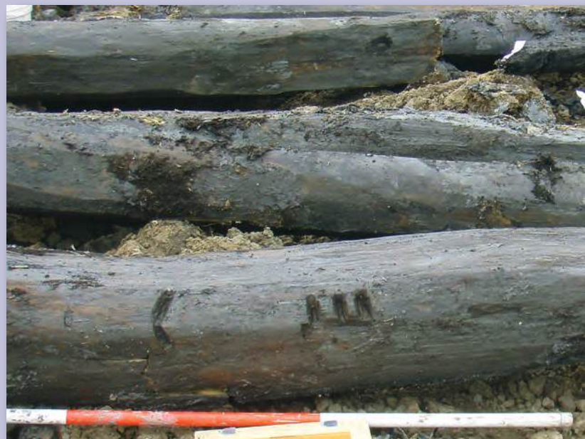
6.35 Een vlotmerk op de ronde kant van een paal.
