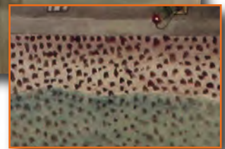
7.41 Detail van het wormspijkerpantser op de huid van de koopvaarder.
