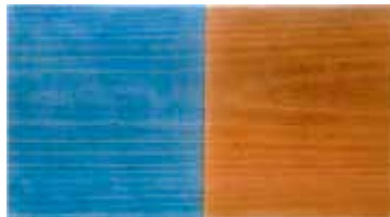
Muestra de pino teñida en azul y en nogal, barnizada con barniz incoloro.
