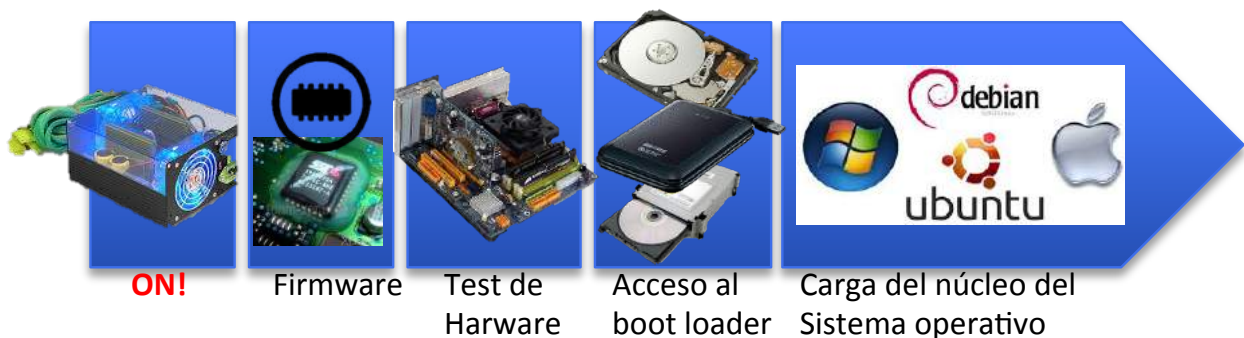
Figura 5.2: Proceso de arranque de un computador.
