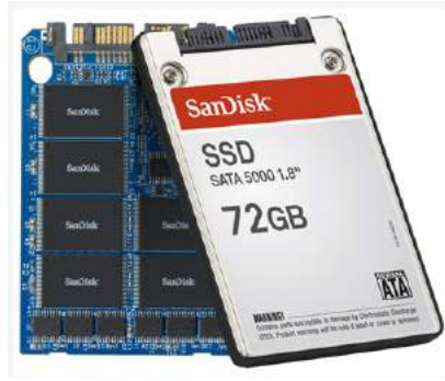
Figura 4.20: Interior de una unidad SSD
