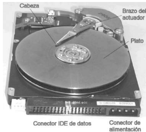
Figura 4.15: Interior de un disco duro
