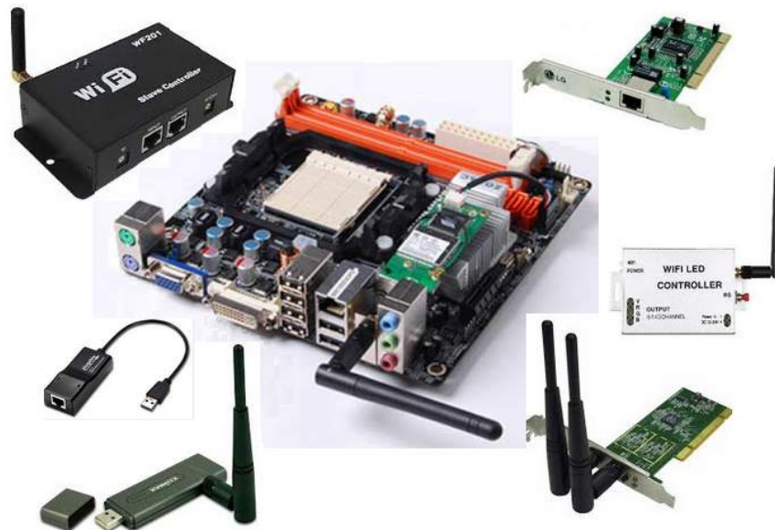
Figura 4.24: Controladores/adaptadores de red Ethernet y Wifi
