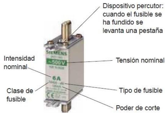
Fusible de cuchillas (SIEMENS AG).
