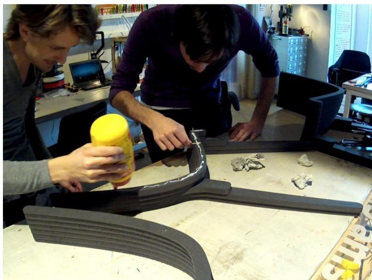
Figura 47: Processo de fabricação colagem das camadas para obter a cadeira tridimensionalmente.
