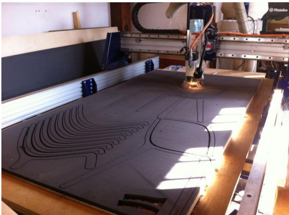
Figura 46: Processo de fabricação na cortadora a laser.
