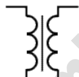
Transformador núcleo de Fe-Si
