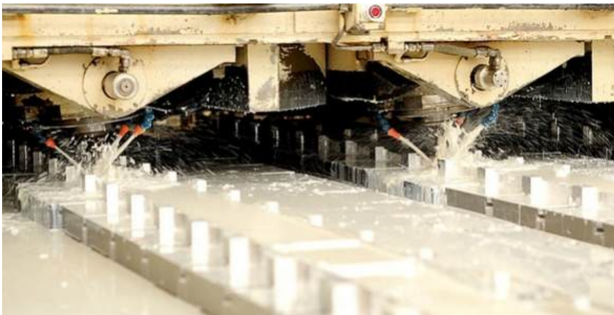
Figura 5- Usinagem das placas
