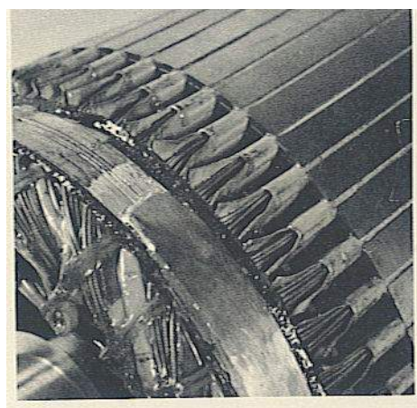
Grupos de bobinas del rotor devanado.
