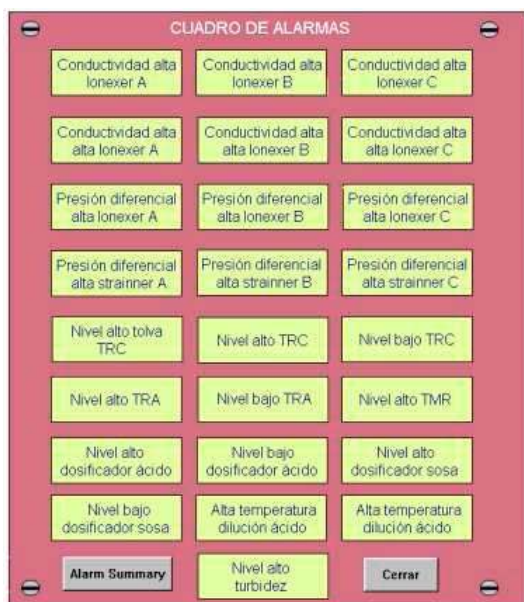
Figura 7.19: Ventana de alarmas.
