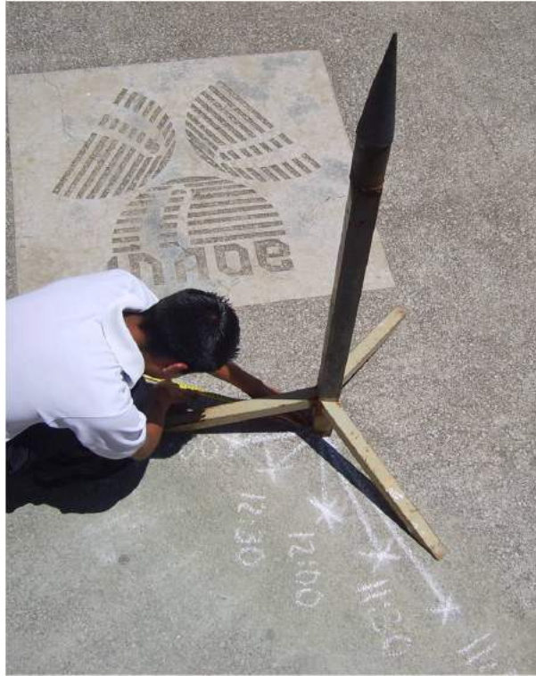
Figura 1.6: Trazos de las sombras del tripié en el suelo para varios tiempos. En el extremo de la sombra se trazó una cruz para denotar la longitud de la sombra en cada tiempo. Los tiempos están anotados junto a la cada línea.
