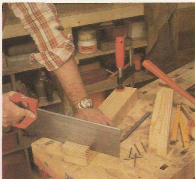
1. Entalhe inglês: execução do rebaixo
