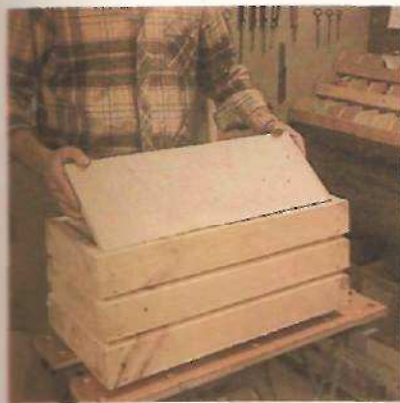
11. Colocação do fundo
