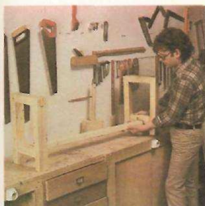
16. Colocação de travessa
