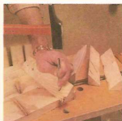
4. Primeira fixação dos suportes angulares
