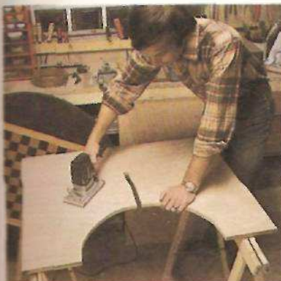
20. Utilizando a lixadeira elétrica
