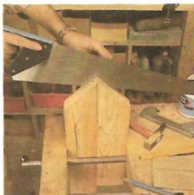
3. Execução dos entalhes
