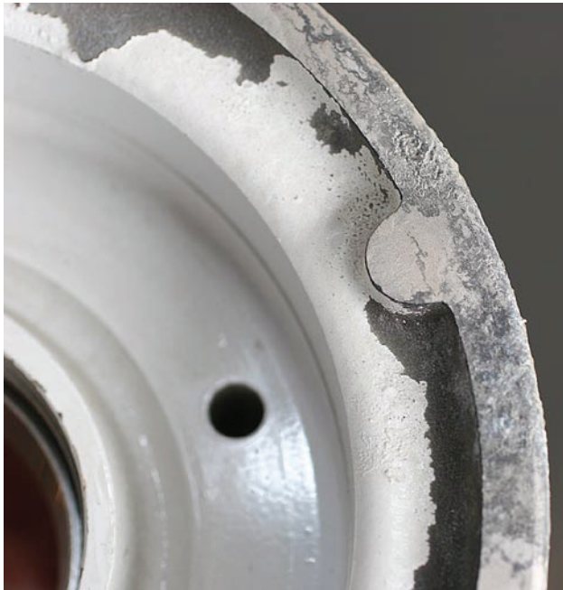
Figura 6-17. Corrosão no magnésio.
