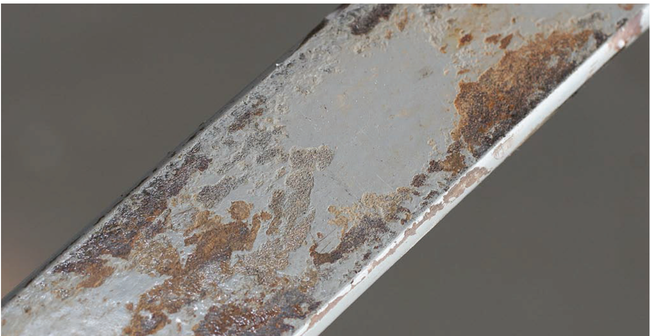
Figura 6-10. Corrosão por atrito.
