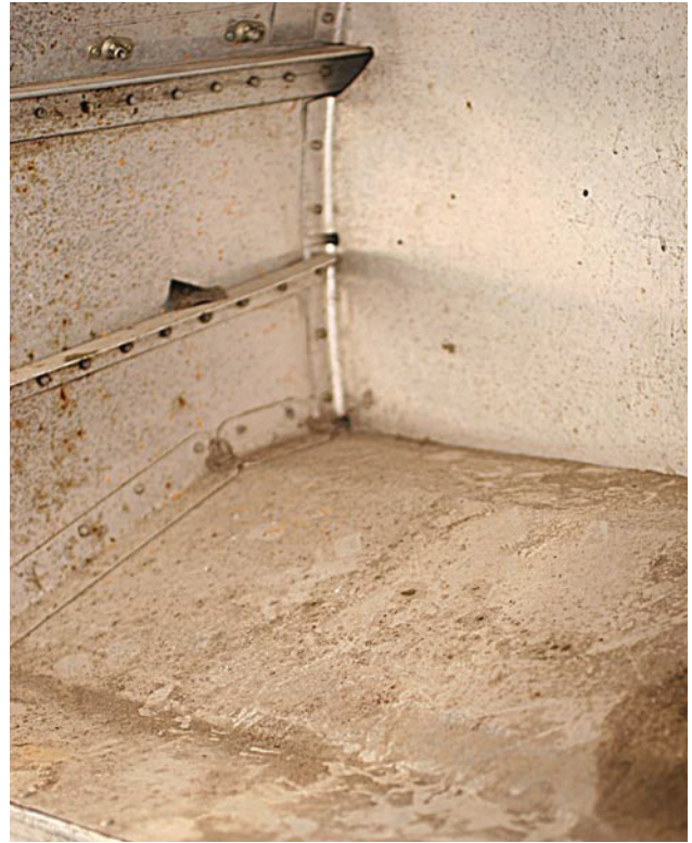
Figura 6-2. Ataque químico direto em um compartimento de bateria.
