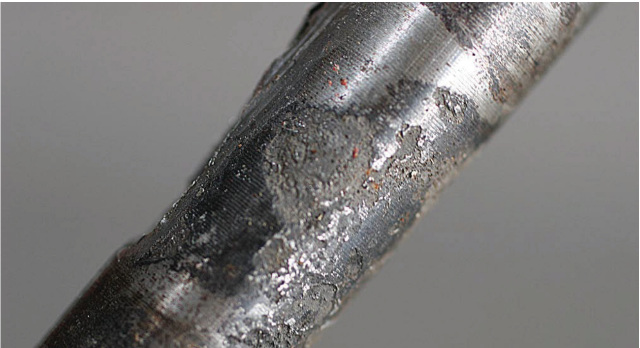
Figura 6-7. Corrosão metálica dissimilar.
