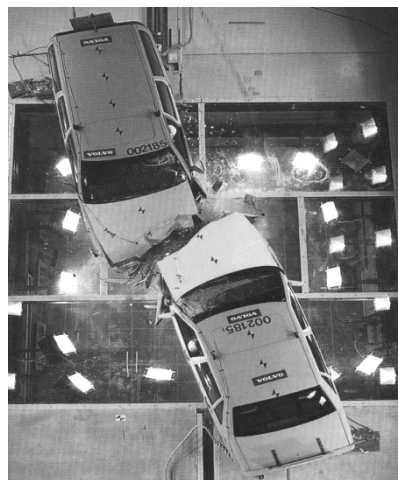
Centro de Seguridad Automotriz Volvo (Goterburgo, Suecia). Se producen colisiones de diverso tipo para simular los efectos de un choque y perfeccionar los sistemas de protección a los ocupantes del vehículo.
