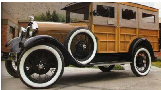
Ford A Station Wagon fabricado en 1929. Motor 4 en línea, 40 HP a 220 RPM. Velocidad máxima: 100km/h
