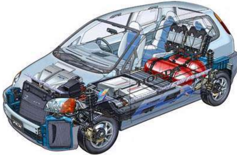
Disposición interna de un vehículo Honda a hidrógeno
