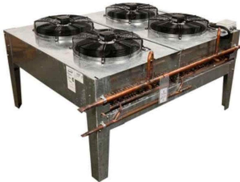
Condensador de 20 HP de calor con ventiladores de 500 mm para R404. Impulsa 9300 m 3 /h (Cortesía de Good Cold SA)
