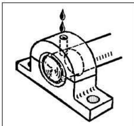
· é importante que o projeto de construção dos mancais de deslizamento contemple a facilidade de desmontagem e troca de equipamentos, bem como a compatibilidade entre o dimensionamento dos mancais com as cargas que os sujeitarão.
