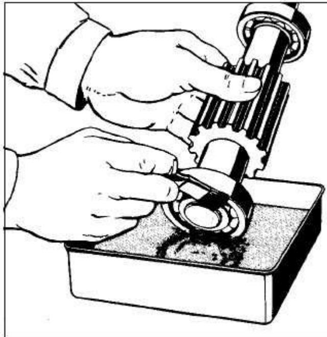
e) Secar o rolamento lavado com um pano limpo sem fiapos ou com ar comprimido. Se for aplicado ar comprimido, cuidar para que nenhum componente do rolamento entre em rotação.
