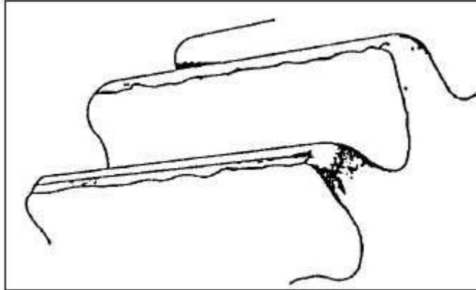
A laminação ou cilindramento também pode apresentar-se como depressão no flanco da engrenagem motora e uma lombada próxima da linha do diâmetro primitivo da engrenagem movida. É causada pelo impacto sofrido pela engrenagem, devido à ação de rolar e deslizar sob carga pesada.
