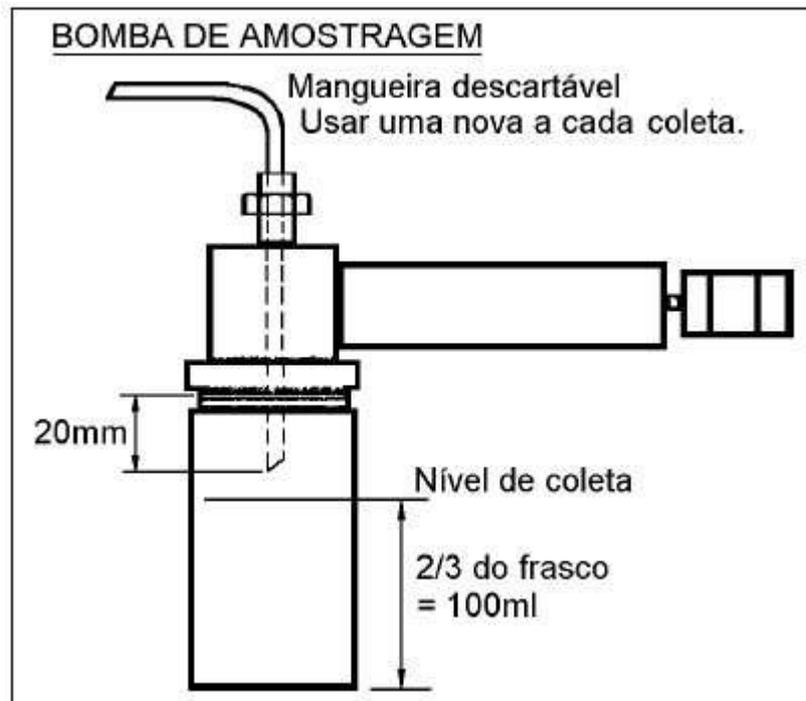
O método de coleta que envolve o uso de uma bomba de coleta deve obedecer aos passos:
