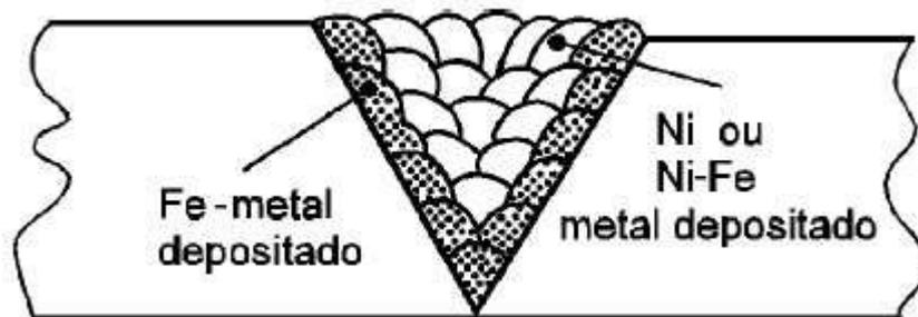
Para o ferro fundido há duas possibilidades de revestimentos de chanfro (amanteigamento):
