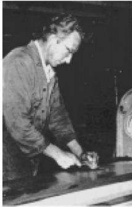
· a mão esquerda deverá agarrar o corpo do rasquete e guiá-lo durante o ataque à peça, na direção do impulso e no retrocesso, mantendo a pressão necessária.
