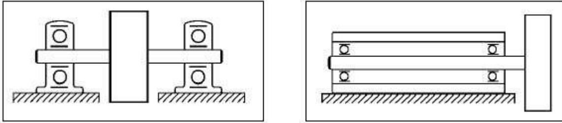
Em certos tipos de máquina, os rolamentos são montados diretamente no corpo delas. Os redutores são um exemplo. Em tais casos, o fabricante da máquina deve projetar e produzir tampas e porcas, bem como projetar o sistema de vedação e de lubrificação.
