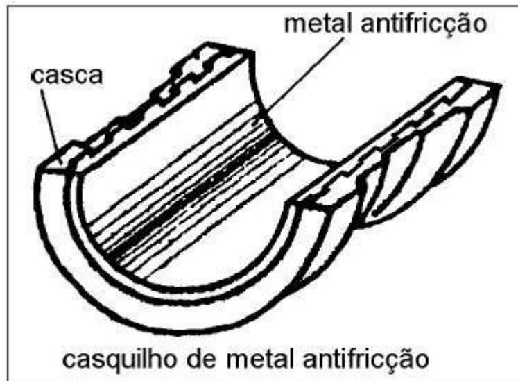
Para materiais de alta resistência utilizam-se buchas substituíveis, bipartidas ou não, com canais de lubrificação. Nesses casos, a recuperação consiste em substituir os elementos deteriorados por novos elementos.
