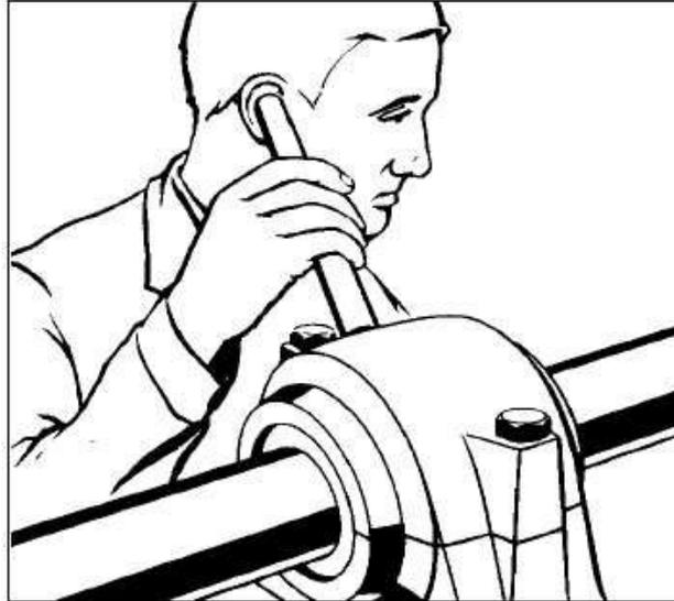
Além dos ruídos, outro fator a ser observado nos rolamentos é a temperatura. A temperatura pode ser verificada por meio de termômetros digitais, sensíveis aos raios infravermelhos. Outra maneira de verificar a temperatura de um rolamento é aplicar giz sensível ou, simplesmente, colocar a mão no alojamento do rolamento.
