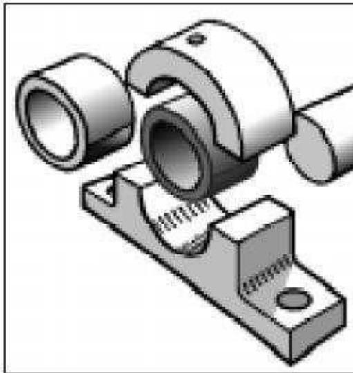
· na construção de mancais de deslizamento, o projeto deverá levar em conta, além das funções próprias desses elementos, o meio ambiente no qual eles trabalharão. Normalmente, o ambiente no qual os mancais de deslizamento trabalham é cheio de poeira e outros resíduos ou impurezas.
