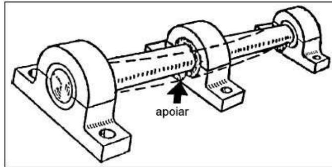
Os mancais de deslizamento são elementos de máquinas sujeitos às forças de atrito. Tais forças surgem devido à rotação dos eixos que exercem cargas nos alojamentos dos mancais que os contêm.
