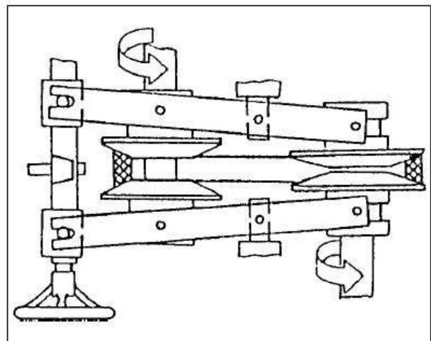
**Variador por roda de fricção** - Transmite o momento de giro por fricção entre duas árvores paralelas ou que se cruzam a distâncias relativamente curtas.
