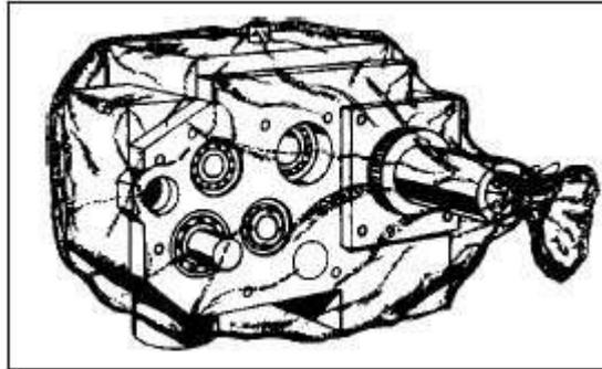
d) Lavar o rolamento exposto, onde é possível fazer uma inspeção sem desmontá-lo. A lavagem deve ser efetuada com um pincel molhado em querosene.
