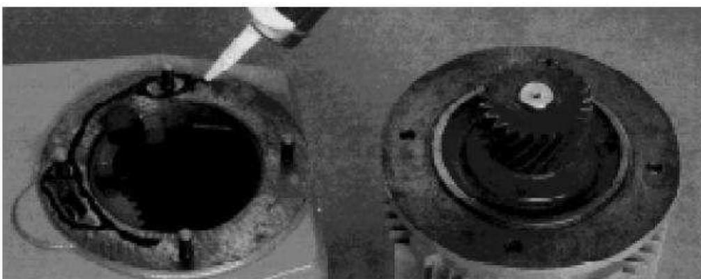
A utilização deste tipo de vedação limita-se a uma folga de até 0,25 mm. Acima deste valor, exige-se o emprego de uma junta espaçadora que deve ser utilizada em conjunto com o vedante anaeróbico.
