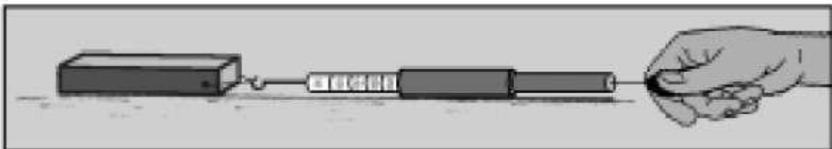
Quando a força de atrito estático atinge o valor máximo, o bloco começa a se deslocar; porém, agora, sujeito a força de atrito dinâmico de deslizamento, que é menos intensa que a força de atrito estático máxima.
