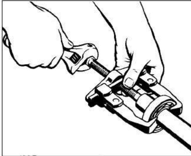
Quando não for possível alcançar a face do anel interno, o saca-polias deverá ser aplicado na face do anel externo, conforme figura abaixo. Entretanto, é importante que o anel externo seja girado durante a desmontagem. Esse cuidado garantirá que os esforços se distribuam pelas pistas, evitando que os corpos rolantes (esferas ou roletes) se marquem.
