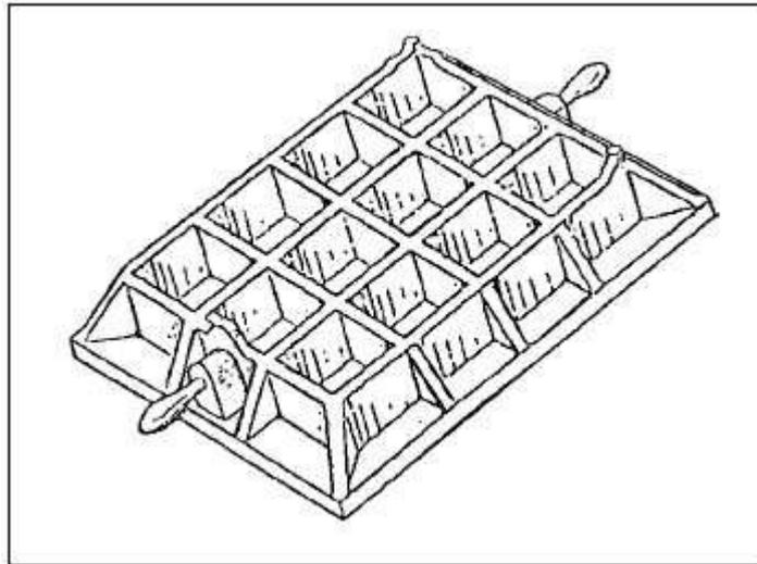
As mesas de controle são fabricadas em tamanhos padronizados e utilizadas para verificar os pontos de apoio das superfícies planas rasqueteadas.
