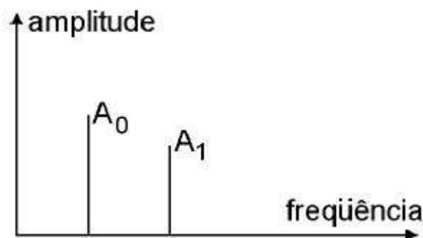
No ponto A0 temos a amplitude de uma certa vibração, e no ponto A1 a amplitude de uma outra vibração. Desse modo, em um espectro todos os componentes de um nível vibratório são representados sob a forma de picos que nos permitem seguir, individualmente, a variação da amplitude de cada vibração e discriminar, sem mascaramentos, os defeitos em desenvolvimento nos componentes das máquinas.
