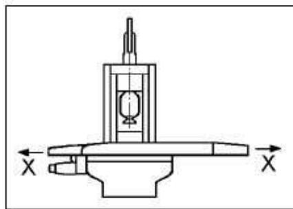
Resumindo, os elementos relacionados entre si devem ser nivelados e alinhados geometricamente nos planos horizontais e verticais, e esses planos devem ser nivelados e alinhados entre si.
