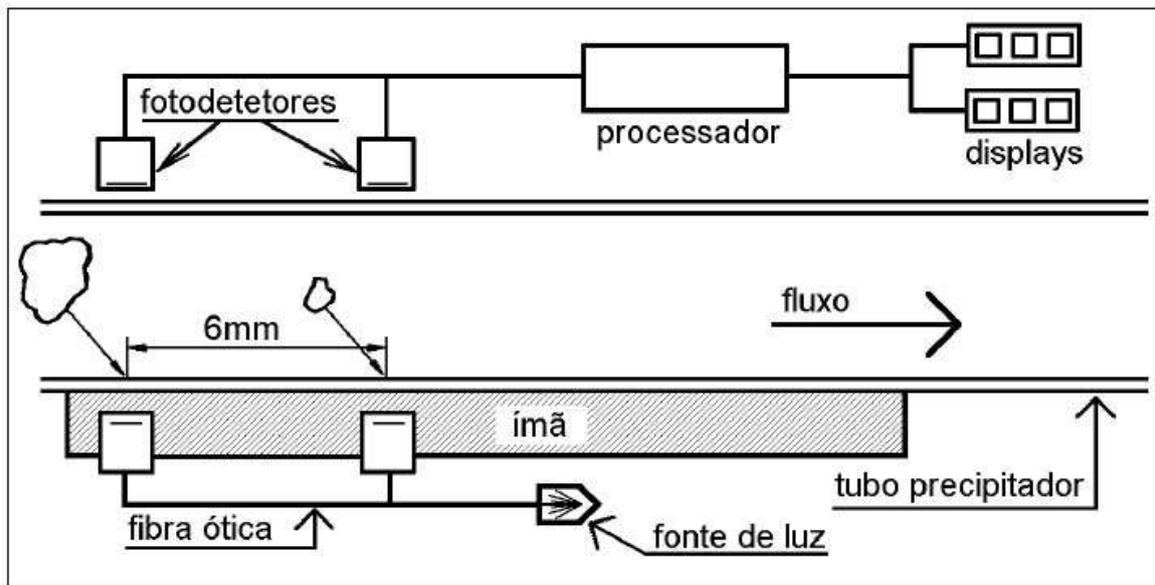
A luz, proveniente da fonte, divide-se em dois feixes que passam por uma fibra óptica. Esses feixes são parcialmente atenuados pelas partículas nas posições de entrada e seis milímetros abaixo. Os dois feixes atenuados são captados por sensores ópticos ou fotodetecores que mandam sinais para um processador, e os resultados são mostrados digitalmente em um display de cristal líquido.
