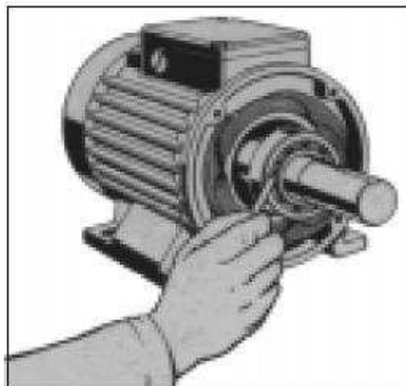
c) Impedir que sujeira e umidade penetrem na máquina, após a remoção das tampas e vedadores. Em caso de interrupção do trabalho, proteger a máquina, rolamentos e assentos com papel parafinado, plástico ou material similar. O uso de estopa é condenável, pois fiapos podem contaminar os rolamentos.
