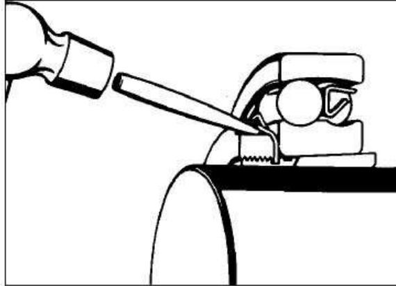
A seguir, o rolamento deverá ser solto da bucha de fixação por meio da martelagem no tubo metálico, conforme explicado anteriormente.
