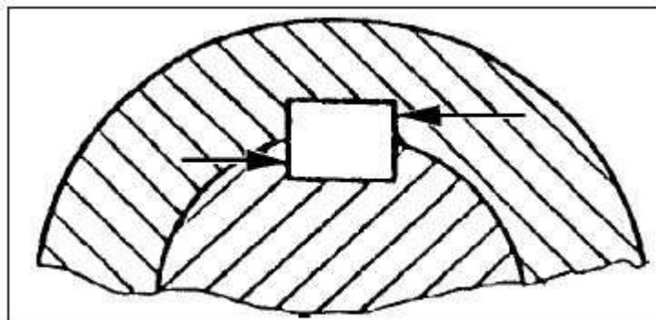
Para evitar o efeito de cunha que poderia partir o cubo do elemento colocado no eixo, a chaveta exige um perfeito ajuste no sentido lateral e vertical.
