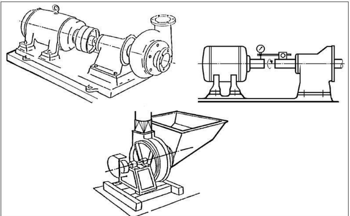
O alinhamento de eixos é feito de diversas maneiras, e os instrumentos e equipamentos utilizados na operação variam de acordo com o grau de exatidão requerido.
