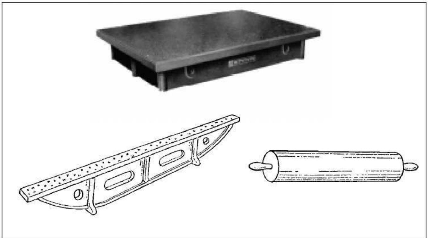
As mesas de controle são pranchas de ferro fundido com superfícies cuidadosamente trabalhadas, isto é, planas e lisas. A parte inferior das mesas de controle são providas de nervuras que evitam suas deformações.
