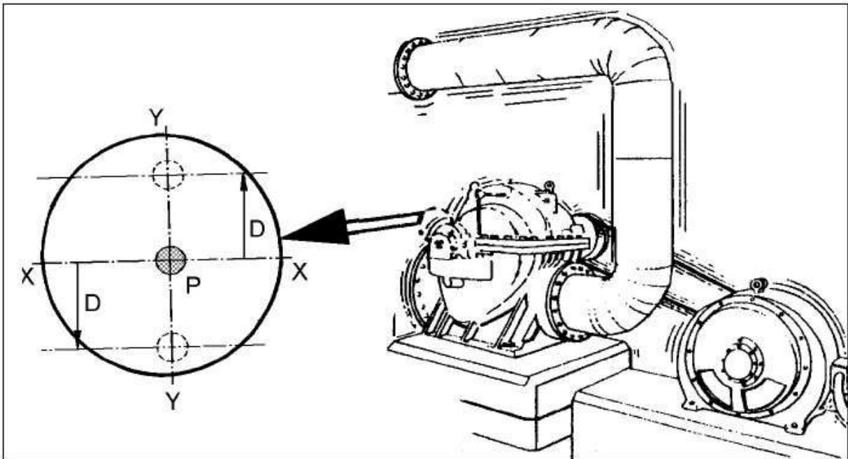
A Pois bem, vibração mecânica é um tipo de movimento, no qual se considera uma massa reduzida a um ponto ou partícula submetida a uma força. A ação de uma força sobre o ponto obriga-o a executar um movimento vibratório.
