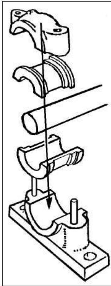
Nas ilustrações a seguir, temos outras formas construtivas de mancais de deslizamento. A primeira ilustração, à esquerda, mostra a possibilidade de deslocamento do eixo provocado pela ação de forças axiais nele atuantes. A outra ilustração apresenta uma solução construtiva que elimina a possibilidade de deslocamento do eixo com a aplicação de anéis de ajuste e travamento, colocados nas laterais do mancal.
