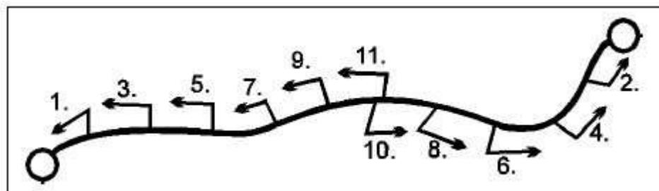
A solda alternada com cordões curtos tem a finalidade de manter um baixo aporte de calor na peça e diminuir ao máximo as tensões de soldagem e conseqüentemente a deformação.
