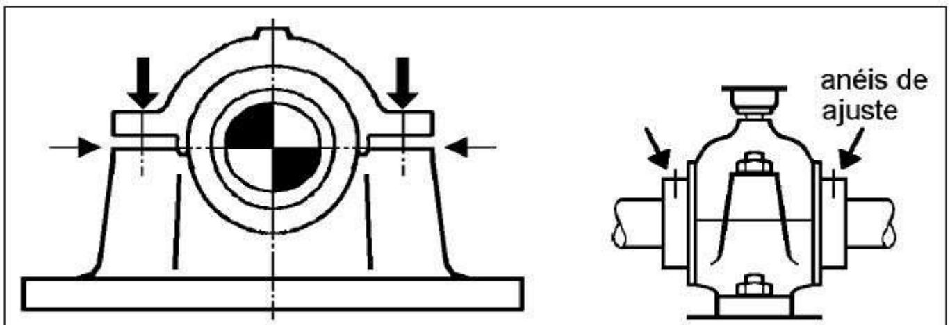
Em determinadas máquinas ou equipamentos que apresentam eixos longos transmissores de torque, são empregados mancais de deslizamento associados.
