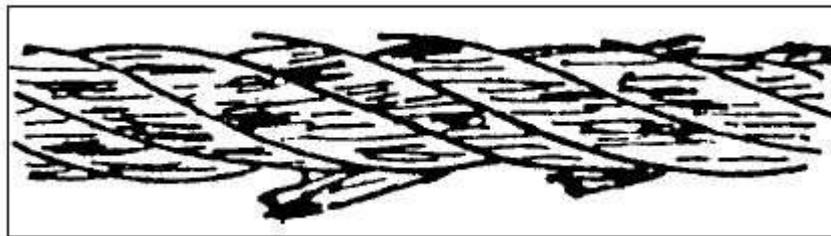
**Ondulação** - Trata se de deslizamento de uma ou mais pernas por causa da fixação imprópria ou do rompimento da alma do cabo de aço. Nesse caso a fixação deverá ser corrigida.
