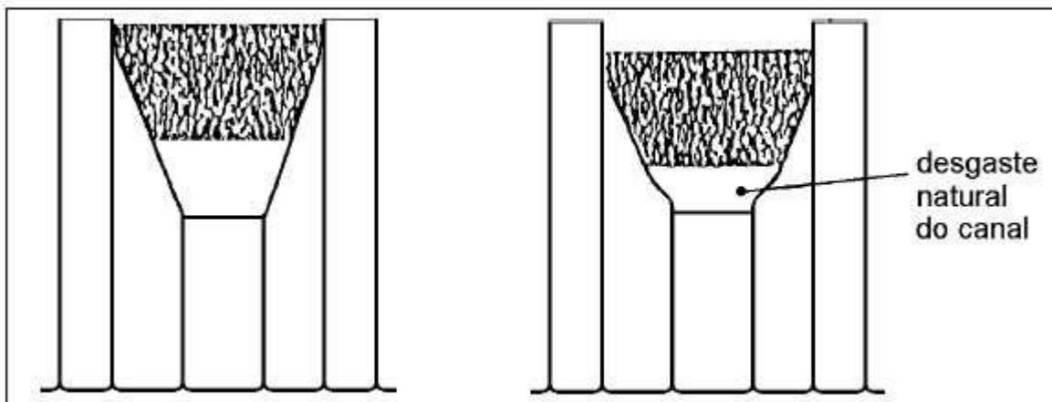
A verificação do dimensionamento dos canais das polias deve ser feita com o auxílio de um gabarito contendo o ângulo dos canais.
