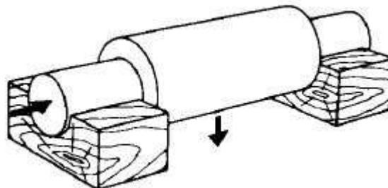
**Mancais de rolamento** - São aqueles que comportam esferas ou rolos nos quais o eixo se apoia. Quando o eixo gira, as esferas ou rolos também giram confinados dentro do mancal. Por exemplo, se colocarmos esferas ou rolos inseridos entre um eixo e um bloco, conforme figura ao lado, o eixo rolará sobre as esferas ou rolos.
