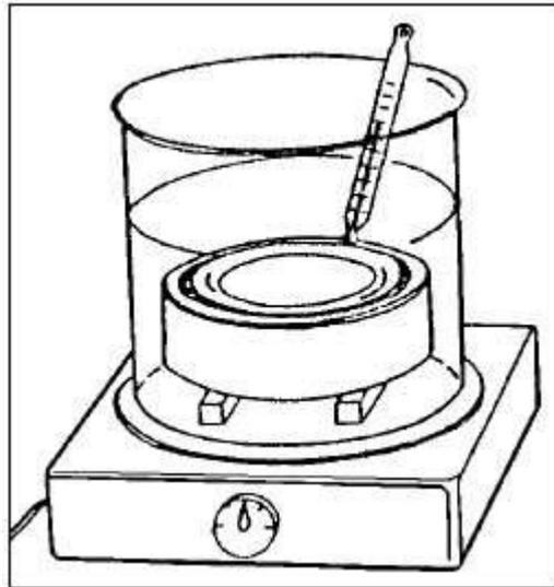
Se o rolamento for do tipo que apresenta lubrificação permanente, ele não deverá ser aquecido conforme descrito anteriormente. O aquecimento remove o lubrificante e o rolamento sofrerá danos.
