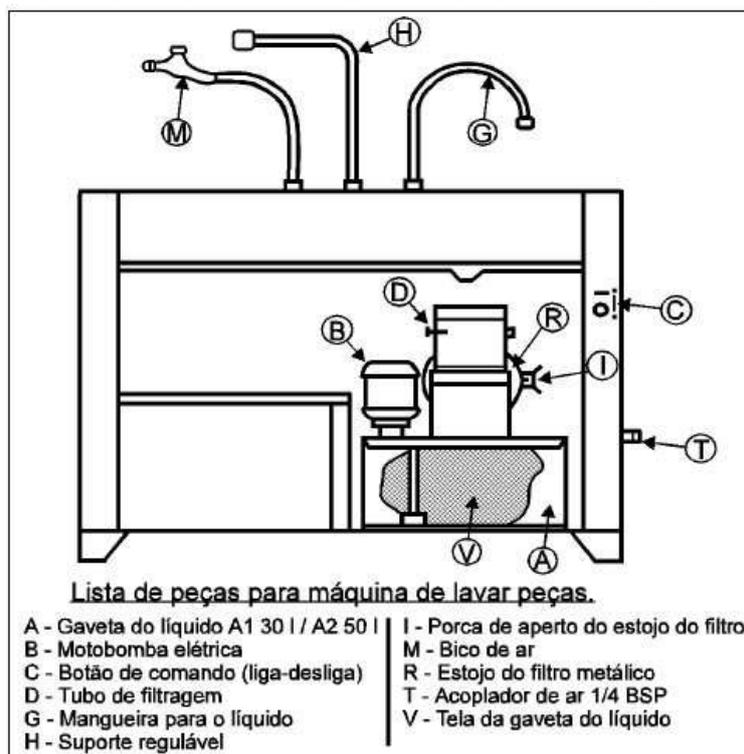
a) Colocar as peças dentro da máquina de lavar, contendo querosene filtrado e desodorizado. Não utilizar óleo diesel, gasolina, tiner ou álcool automotivo, pois são substâncias que em contato com a pele podem provocar irritações.
