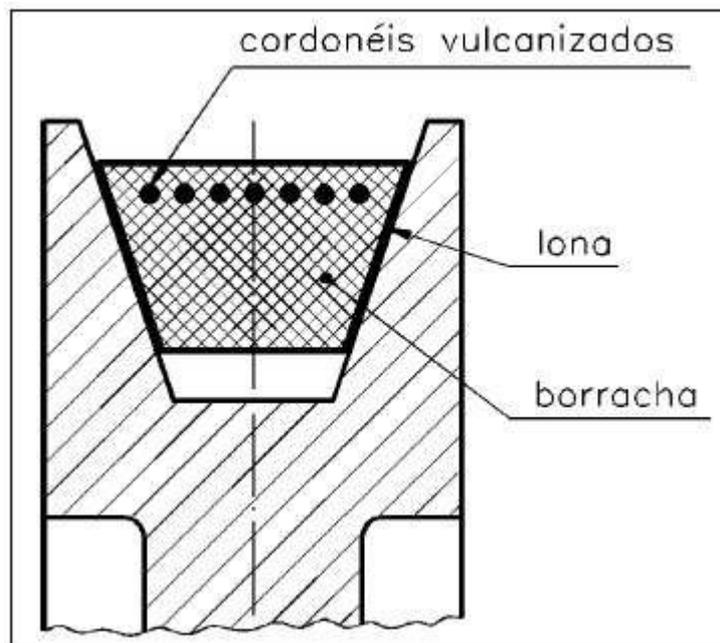
Existem cinco perfis principais padronizados de correias em “V” para máquinas industriais e três perfis, chamados fracionários, usados em eletrodomésticos. Cada um deles tem seus detalhes, que podem ser vistos nos catálogos dos fabricantes.
