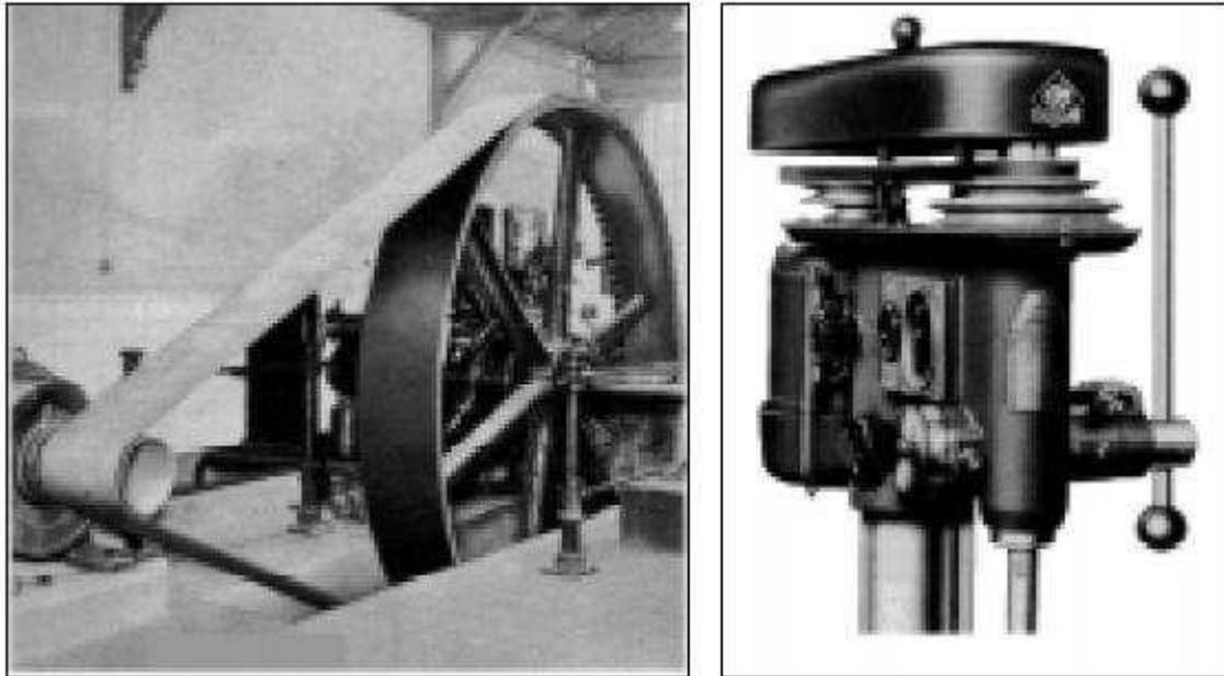
Os materiais empregados na fabricação de correias são os seguintes: borracha; couro; materiais fibrosos e sintéticos à base de algodão, viscose, perlon, náilon e materiais combinados à base de couro e sintéticos.
