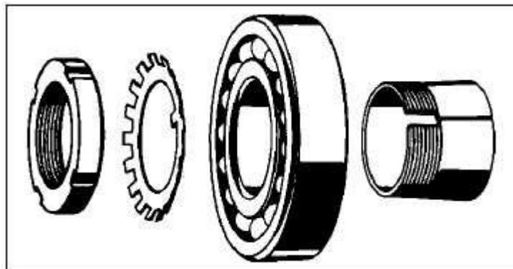
A desmontagem de rolamentos montados sobre buchas de fixação deve ser iniciada após se marcar a posição da bucha sobre o eixo. A orelha da arruela de trava, dobrada no rasgo da porca de fixação, deve ser endireitada, e a porca deverá ser solta com algumas voltas.
