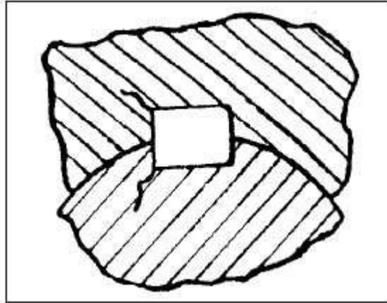
Em condições favoráveis, pode-se trocar uma chaveta paralela por uma do tipo meia-lua. A chaveta tipo meia-lua praticamente elimina problemas com torção, especialmente se o eixo na qual ela irá atuar for temperado.
