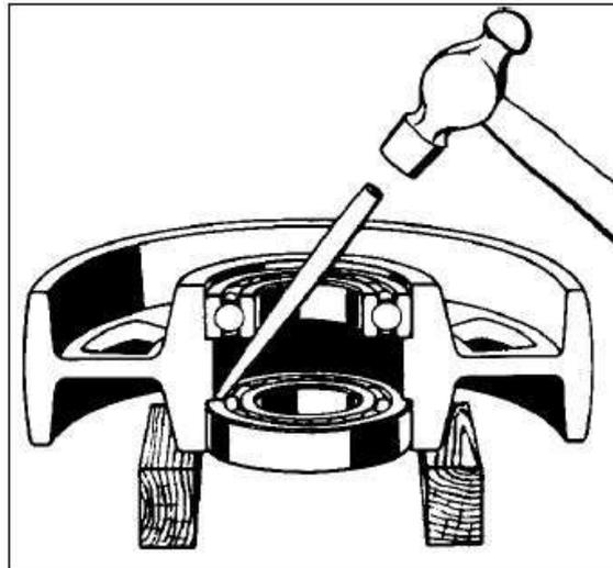
O conjunto do anel interno de um rolamento autocompensador de rolos ou de esferas pode ser desalinhado. O desalinhamento permite o uso de um sacapólias no anel externo.
