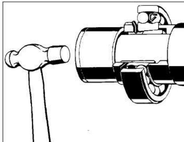
Quando a face da porca estiver inacessível, ou quando não existir um espaço entre o anel interno e o encosto do eixo, a ferramenta deverá ser aplicada na face do anel interno do rolamento.
