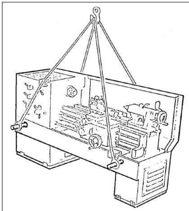
Os elementos de amarração devem estar bem dimensionados para o peso da máquina, e seus componentes móveis bem travados para não sofrerem movimentos e choques com outros conjuntos durante seu transporte.
