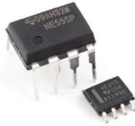
Figura 27. Encapsulado del NE555
