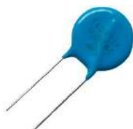
Figura 15. Varistor o VTC
