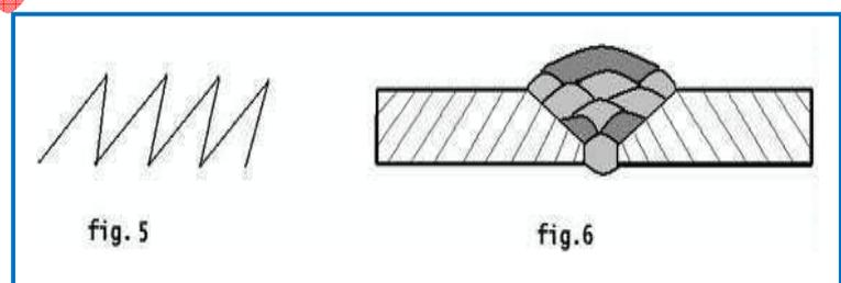
**Soldadura en ángulo en posición plana horizontal:**
