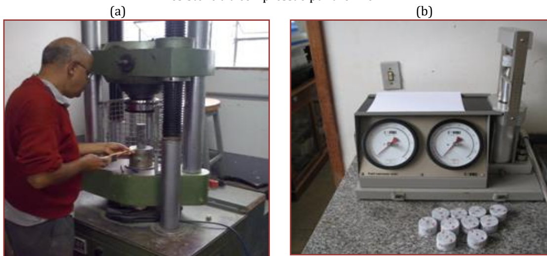
Figura 2. Máquinas e seus aparatos, utilizadas nos ensaios: (a) de resistência à compressão uniaxial; (b) de resistência à compressão puntiforme.
