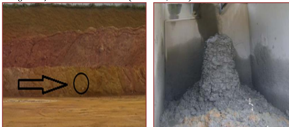
Figura 1. Jazida do solo amostral (Yin e Dias, 2014) e lama abrasiva coletada.
