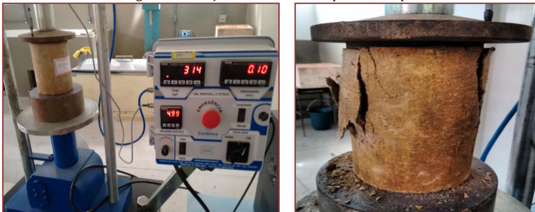
Figura 4. Execução do ensaio de compressão simples.
