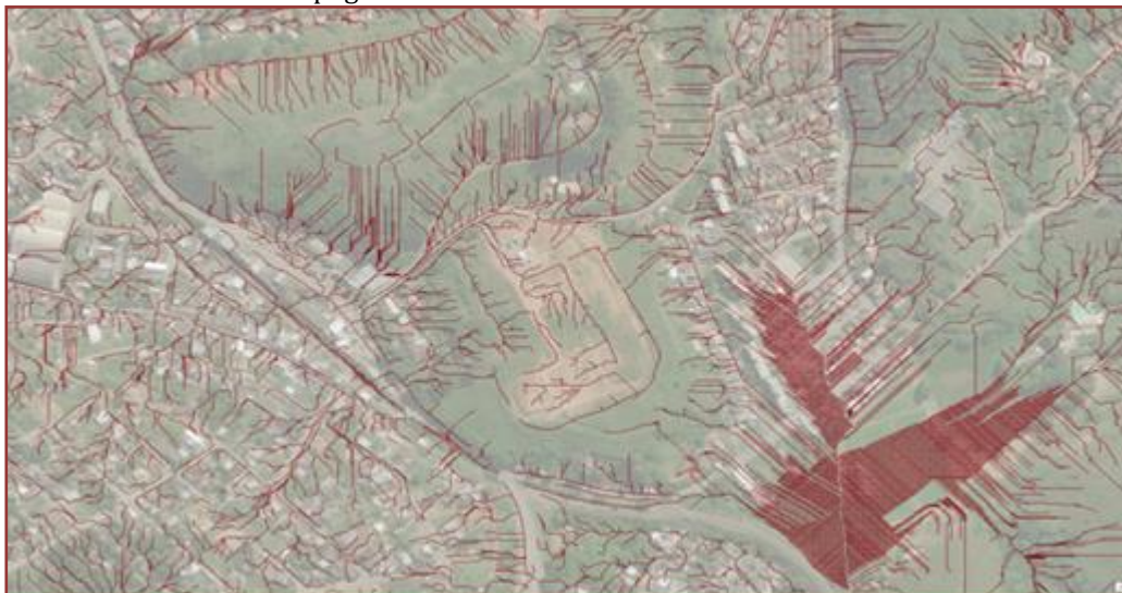
Figura 11 – Sobreposição dos Fluxos e Caminhos que as águas pluviais percorrem, considerando a topografia local em um trecho da zona urbana.
