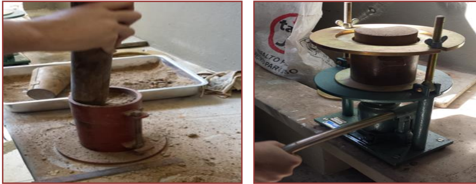
Figura 2. Compactação e desforma dos corpos de prova.
