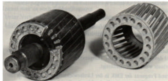
Fig.4.49.: Rotor jaula de ardilla. La jaula es de aluminio fundido.
