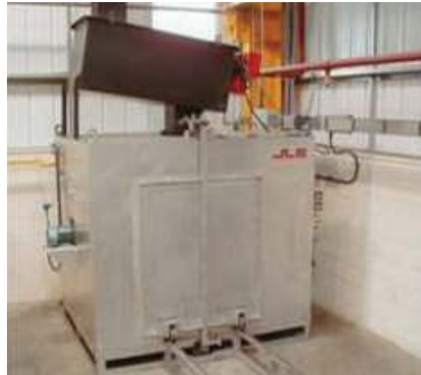
Figura 23. Horno de quemado con temperatura controlada. Figura © EASA
