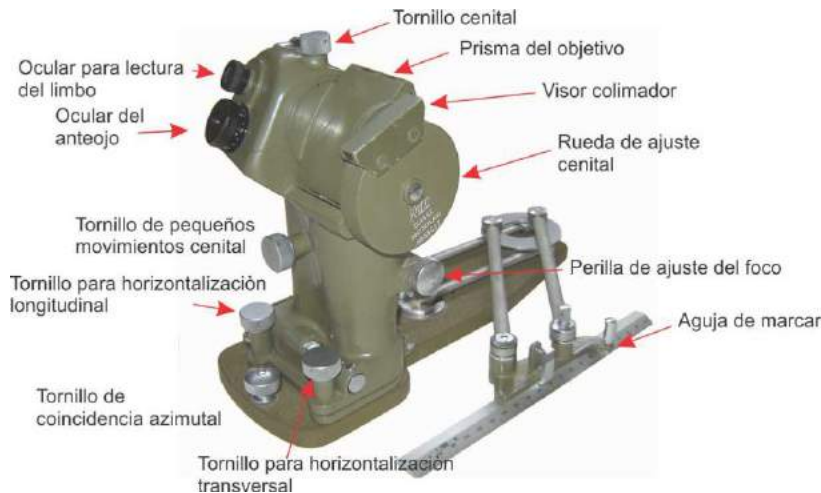
Figura X 4. Alidada autorreductora Kern Aarau RK 360.
