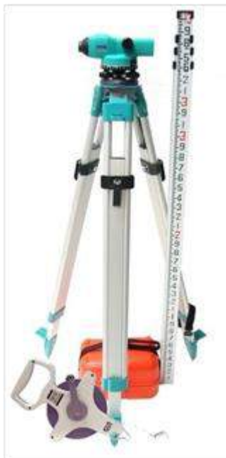
Figura VII 3. Nivel óptico sobre trípode con mira de nivelación y cinta métrica.
