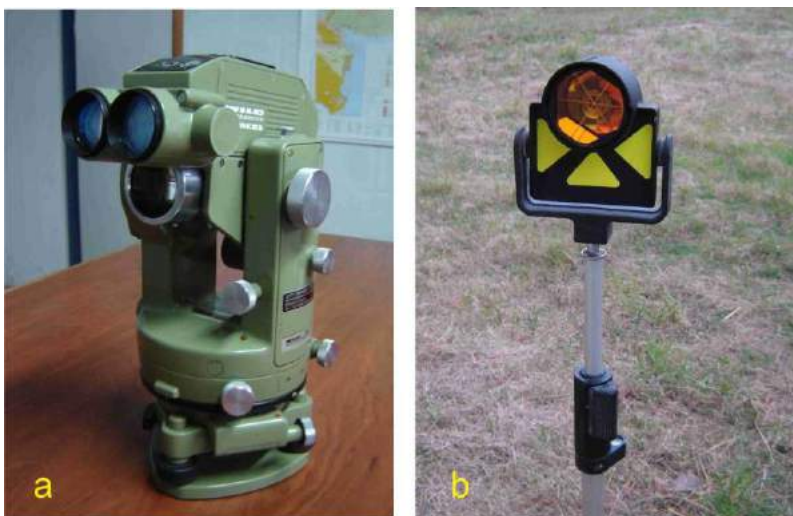
Figura IV 7. a) Distanciómetro Distomat de Wild, montado sobre un teodolito Wild T1. b) Mira de espejo.
