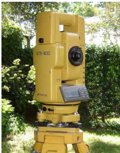
Figura VIII 13. Estación total TOPCON GTS300.
