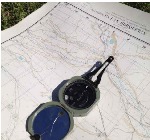
Figura V 18. Orientando el mapa en el campo. El borde de la brújula coincide con el norte magnético (en este caso igual al norte de la cuadrícula) y la punta de la aguja está marcado acimut 0°.
