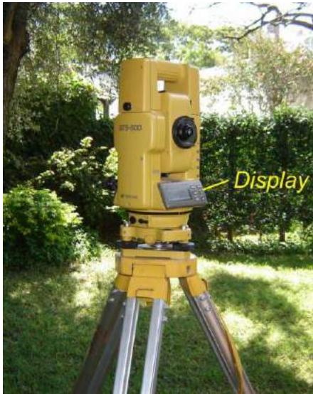
Figura IV 8. Estación total Marca TOPCON.
