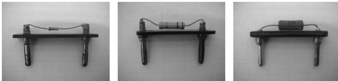
Figura 7 – Exemplo de três modelos de resistores. Em ordem, da esquerda para a direita, quanto à potência que podem dissipar.
