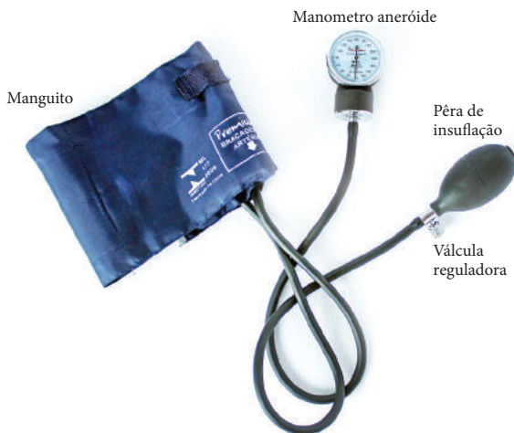
Figura 8 – Composição do esfigmomanômetro
