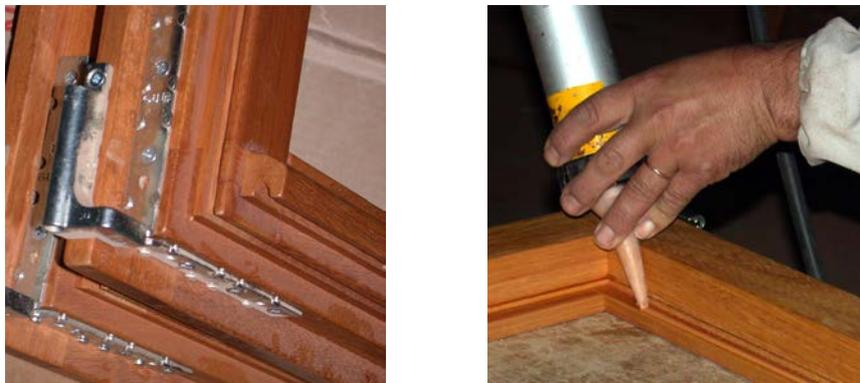
Fig. 41 - Colocação de ferragens (à esquerda) e de vidros (à direita)
