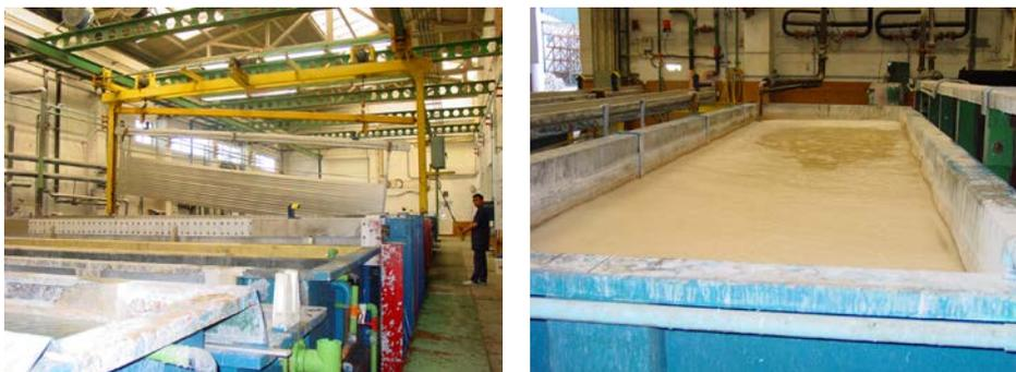
Fig. 50 - Linha de anodização e respectivos tanques
