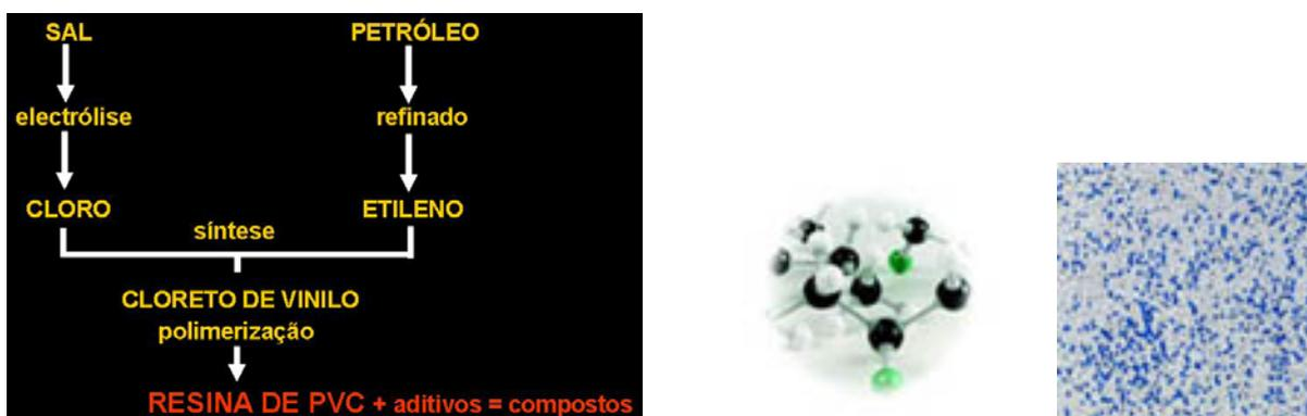
Fig. 68 - Processo de fabrico do PVC (à esquerda), molécula (ao centro) e grânulos de PVC (à direita)
