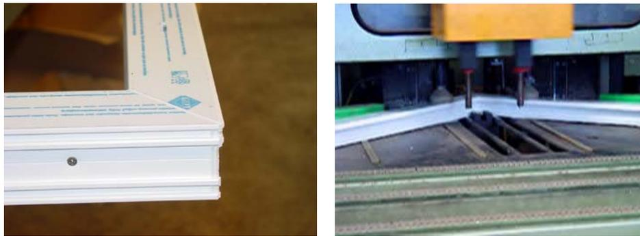
Fig. 79 - À esquerda, aro finalizado com protecção e, à direita, máquina de limpeza dos cordões de soldadura
