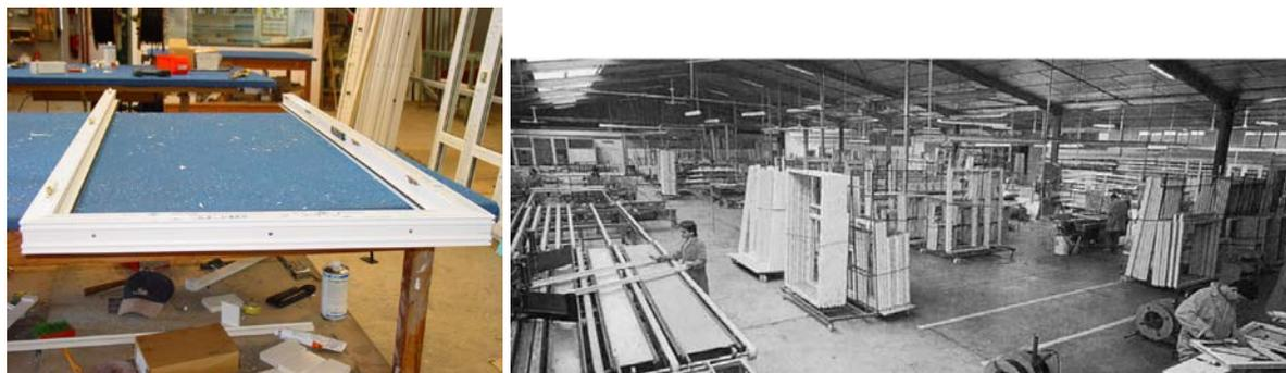
Fig. 81 - Mesa de montagem das ferragens (à esquerda) e armazenagem temporária dos caixilhos (à direita)
