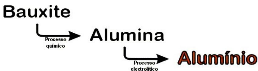
Fig. 43 - Processo de transformação do alumínio
