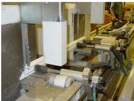
Fig. 66 - Fabrico de um caixilho misto madeira / alumínio
