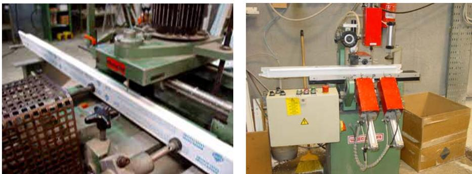
Fig. 75 - À esquerda, abertura de rasgos para puxador e fechadura e, à direita, furações simultâneas
