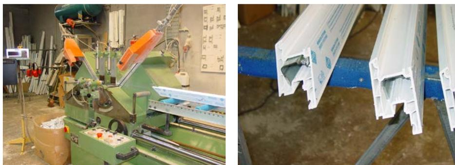
Fig. 74 - À esquerda, máquina de corte e, à direita, perfis cortados
