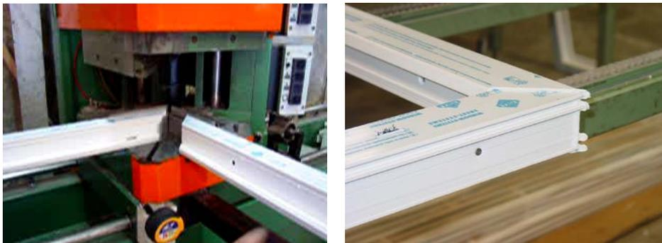
Fig. 78 - À esquerda, soldadura de perfis de PVC e, à direita, cordões de soldadura
