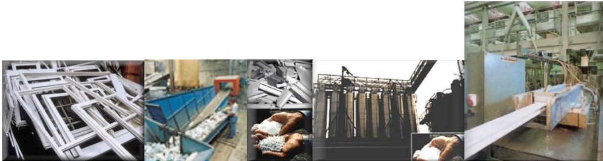
Fig. 83 - Ciclo dos perfis usados ao pó de PVC e de novo a perfis
