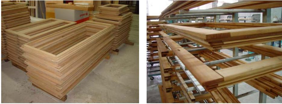
Fig. 40 - À esquerda, aros acabados e, à direita, secagem depois do envernizamento
