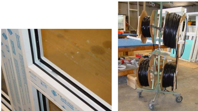
Fig. 80 - À esquerda, perfil pronto a ser montado em obra e, à direita, borrachas de EPDM
