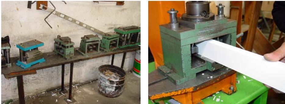
Fig. 59 - À esquerda, matrizes do cunho e, à direita, o próprio cunho
