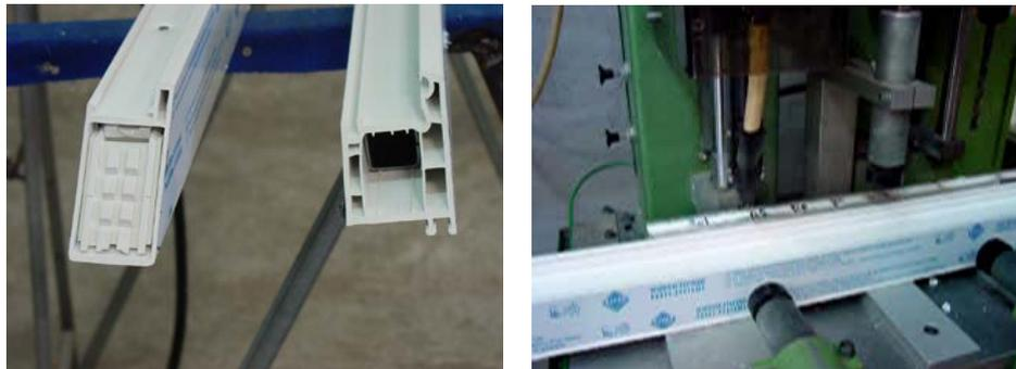
Fig. 76 - À esquerda, reforço do topo de perfis PVC e, à direita, ligação do perfil de reforço ao perfil de PVC
