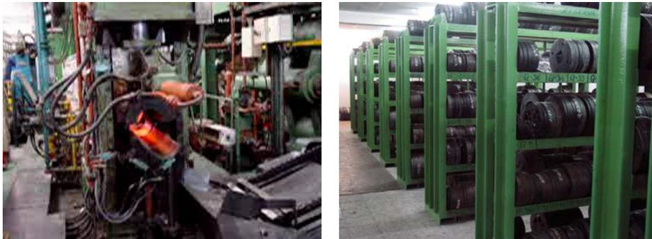
Fig. 48 - À esquerda, prensa hidráulica e, à direita, matrizes
