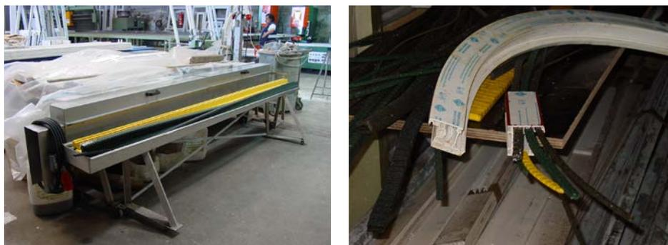
Fig. 77 - À esquerda, máquina para curvar perfis e, à direita, tiras de borracha que são colocadas em torno do perfil para ser curvado
