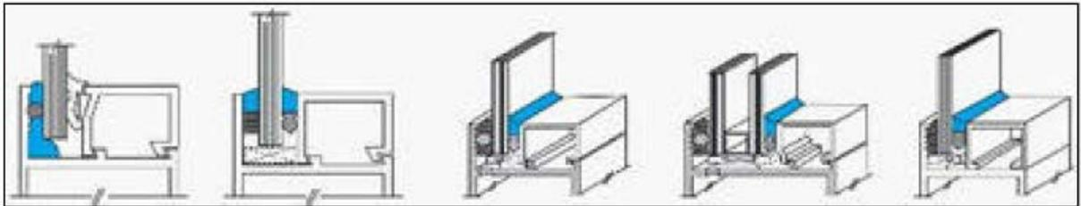
Fig. 96 - Exemplos de aplicação de silicone
