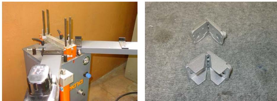
Fig. 60 - À esquerda, máquina de ligar cantos e, à direita, esquadros
