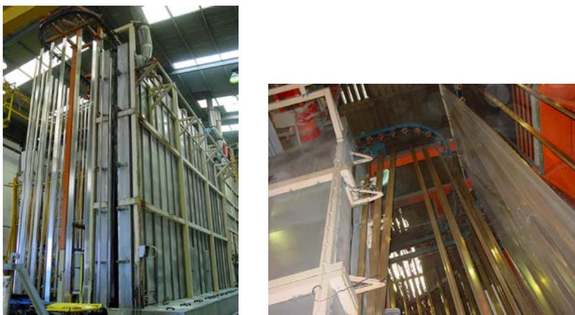
Fig. 54 - Preparação dos perfis para a lacagem: desengorduramento (à esquerda) e tratamento antes da pulverização (à direita)
