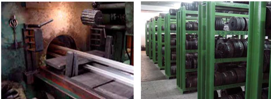
Fig. 49 - À esquerda, perfil à saída da prensa e, à direita, tracção dos perfis
