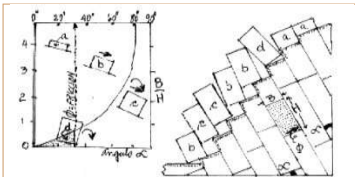
Figura 70. Volcamiento y deslizamiento de bloques. En el macizo: (a) bloques sin volcamiento ni deslizamiento; (d) con volcamiento y sin deslizamiento; (b) con deslizamiento y sin volcamiento; (c) con deslizamiento y volcamiento. En el ábaco se presentan las situaciones anteriores para un bloque sin empuje, en función de la inclinación del piso, de la relación base - altura de los bloques y de la fricción en el piso. Adaptado de E. Hoek and J. Bray, Rock Slope Engineering.
