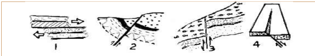
Figura 57. Otros tipos de fallas. 1. Falla conforme si el plano es paralelo a los estratos; 2. Falla contraria si el plano es perpendicular a los estratos; 3. Falla vertical si el plano de falla es vertical; 4. Falla en tijera, charnela o de torsión.
