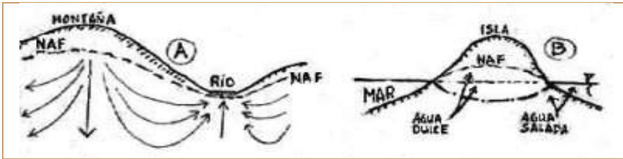
Figura 126. Nivel freático regional: A. bajo una montaña, B. bajo una isla. Se ilustran con flechas el flujo del agua y en línea punteada el NAF. Adaptado de Félix Trombe, Las Aguas Subterráneas.
