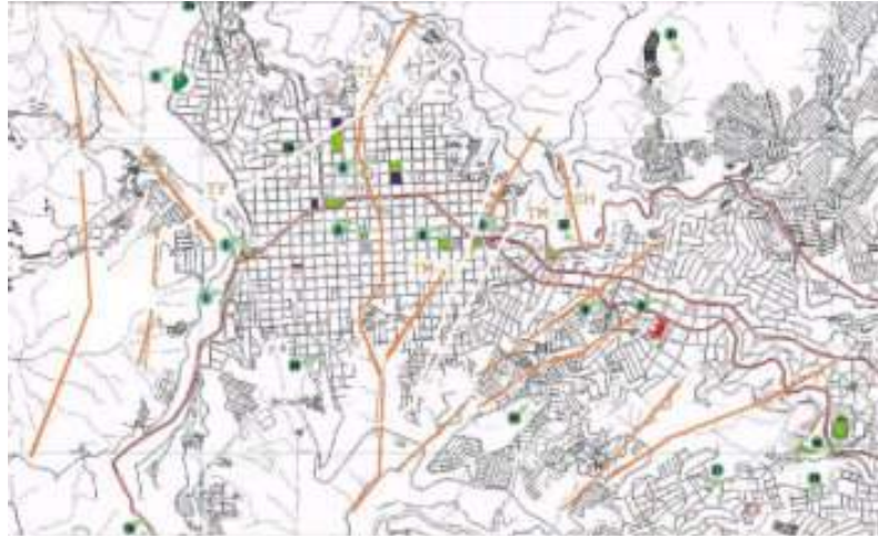
Imagen 59: Manizales: fallas y lineamientos geotectónicos. Al poniente, aparecen los rasgos estructurales del Escarpe de Chipre; por el centro y vecina a la plaza de Bolívar, la Falla Manizales-Aranzazu con dirección Norte Sur, y a partir de ella un set de fallas en abanico pasando por Fundadores, el Cementerio y la Q. San Luis. Fuente, Aguas Manizales & INGESAM.
