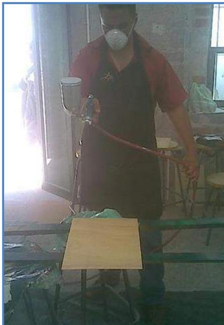
**Fig. 45** Aplicación de tinta al alcohol con poliéster.
