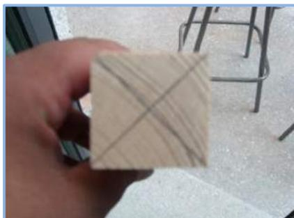
Fig. 24 Trazo en el centro de la pieza.
