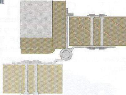
En las bisagras de media superficie, una de las palas se atornilla o fija a la jamba del marco de la puerta, en tanto que la otra se fija o atornilla sobre una de las caras de la puerta, en vez de sobre el canto.
