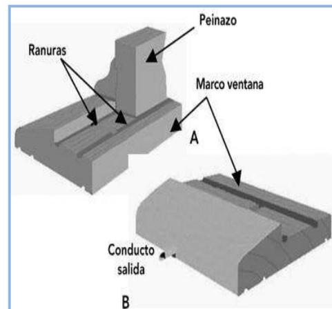
**Fig. 33** A) Detalles de las ranuras que reciben el agua de condensación. B) El conducto de desagüe debe tener una sección igual o superior a 50 mm<sup>2</sup> por cada m<sup>2</sup> de ventana.
