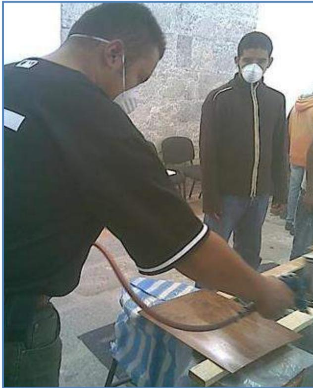
**Fig. 38** Aplicación de tinta a base de agua con sellador.
