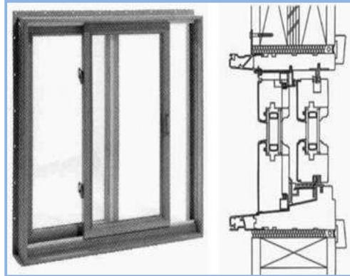
Fig. 25 Ventana de movimiento deslizante.
