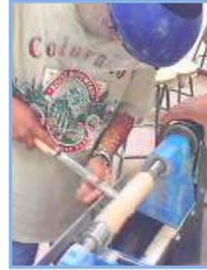
Figs. 65, 66 y 67 Ranurado con fresa partidora.
