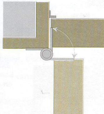
La bisagra embutida de un lado tiene una pala más angosta que otra. La pala estrecha va fija a la cara exterior de la jamba, en tanto que la pala no angosta lleva un doblado que le permite fijarse al canto de la puerta.
