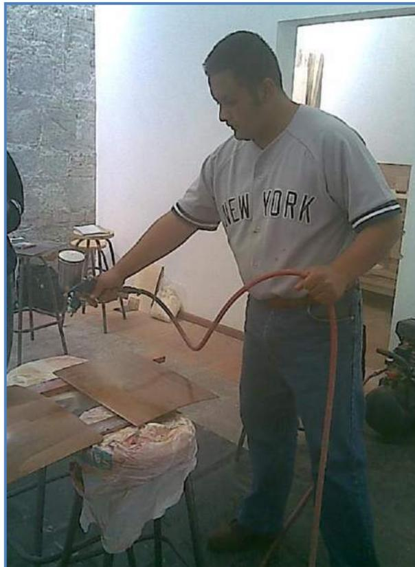
Fig. 44 Aplicación de tinta al alcohol con poliuretano.
