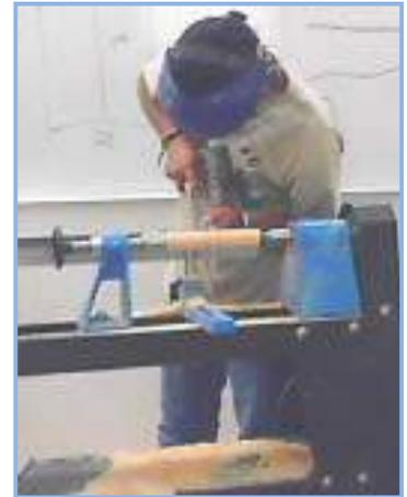
Figs. 46, 47 y 48 Uso de la cuchilla de filo oblicuo y perfilado final.
