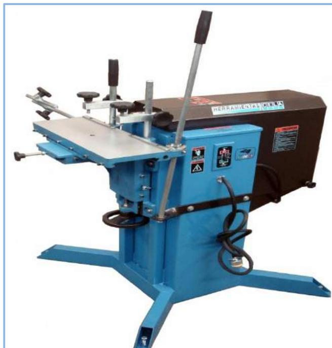
Fig. 27 Escoplo para madera.
