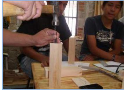
Fig. 25 Fabricación de guía con lanceta.
