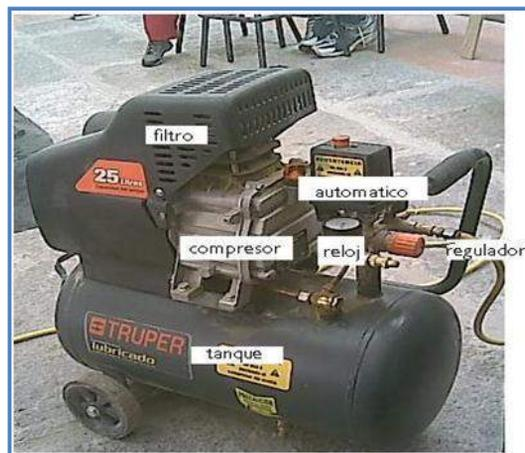
Fig. 9 Partes de una compresora.
