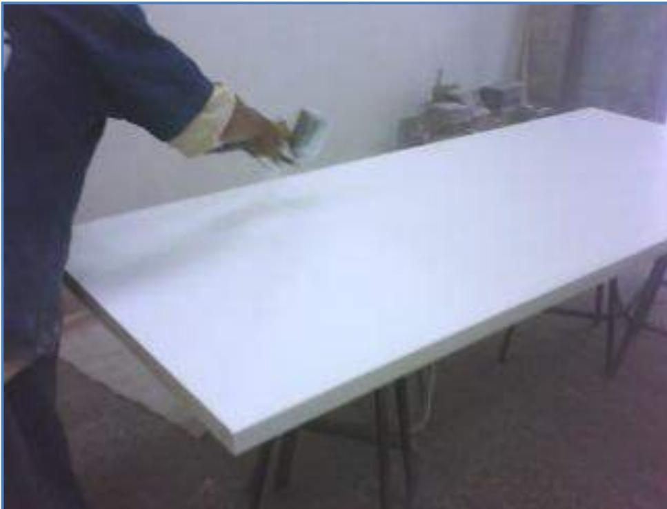
Fig. 42 Aplicación de primer y esmalte.
