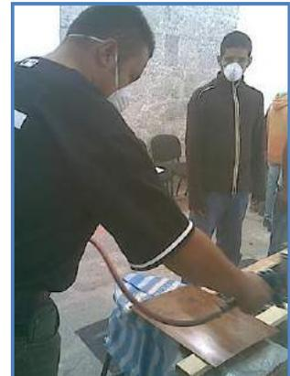
Fig. 37 Aplicación de laca brillante base nitrocelulosa.
