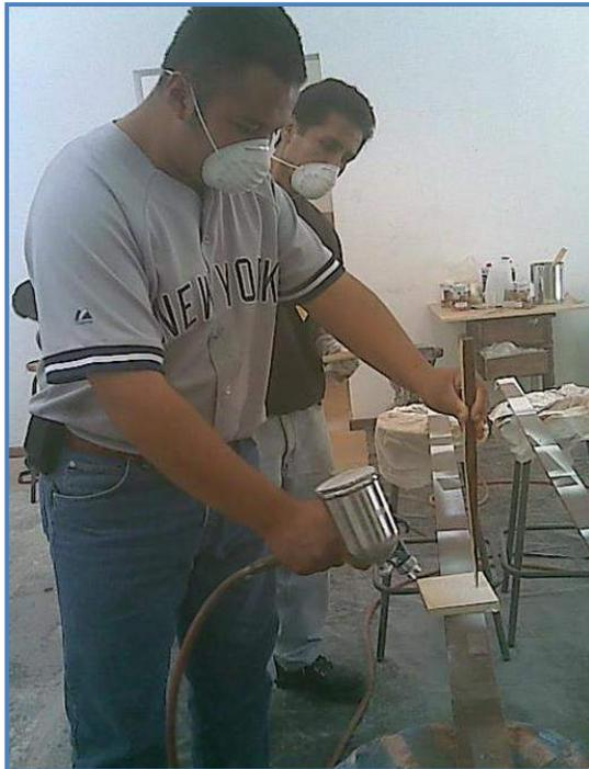
**Fig. 40** Aplicación de sellador y laca mate.
