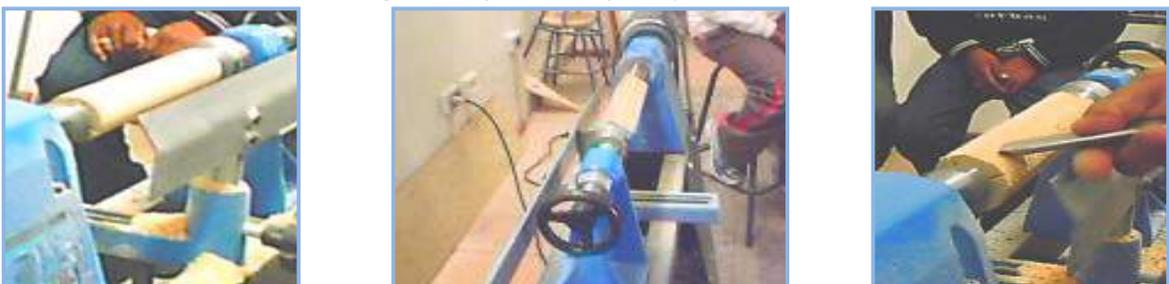
Figs. 43, 44 y 45 Perfilado y corte con gubias.
