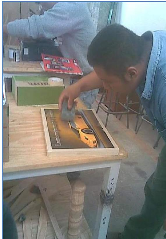
Fig. 46 Aplicación de resina epóxica.
